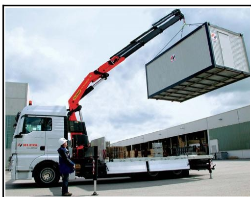
Figure 17 : Une grue de levage du type de celle du tracteur accidenté.
