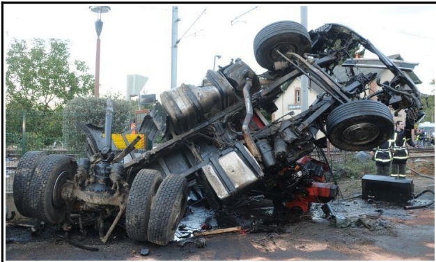
Figure 19 : Le châssis du tracteur routier accidenté, privé de sa cabine et de son troisième essieu. L'avant est en haut.
