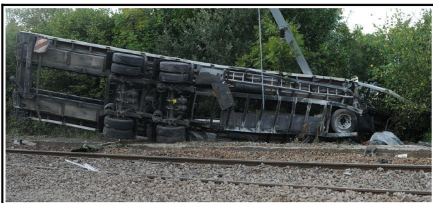
Figure 20 : La semi-remorque accidentée. L'avant et le col de cygne sont à droite.
