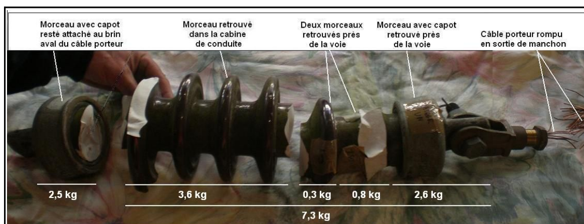
Figure 32 : Les masses des différents morçeaux de l'isolateur retrouvés
