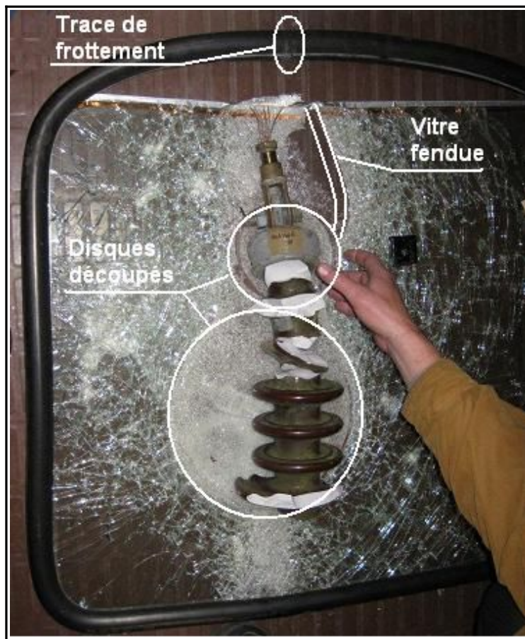
Figure 28 : Présentation de l'isolateur reconstitué sur la vitre endommagée
