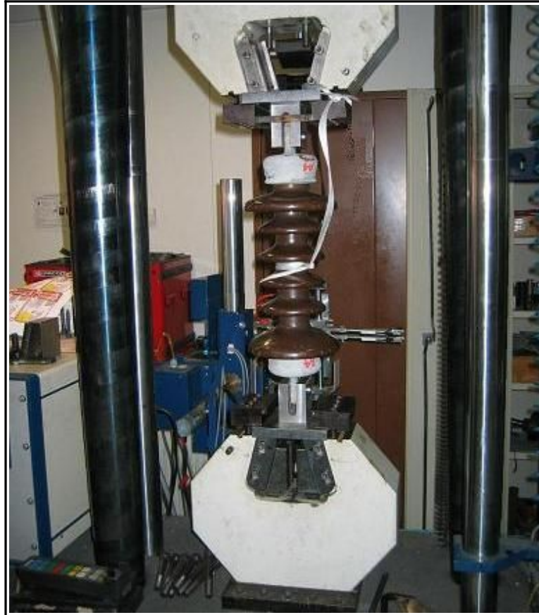
Figure 23 : Essai de résistance à la traction
