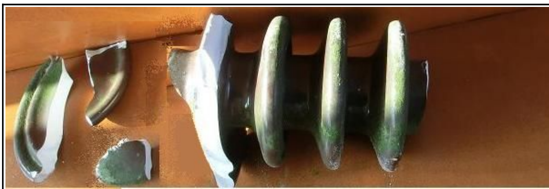
Figure 17 : Morceau et tessons d'isolateur retrouvés en cabine
