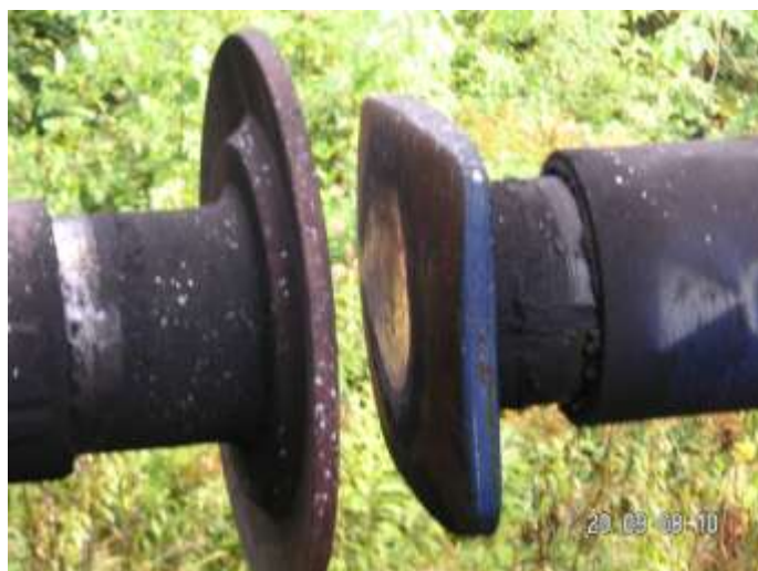
Abbildung 24 10. und 9. Wagen - trockene Pufferteller - Quelle IM
