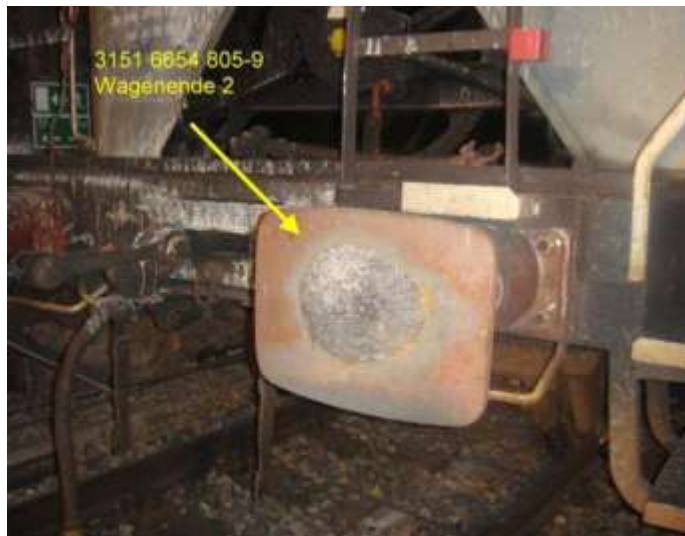
Abbildung 22 6. Wagen - trockener und verrieftter Pufferteller - Quelle IM
