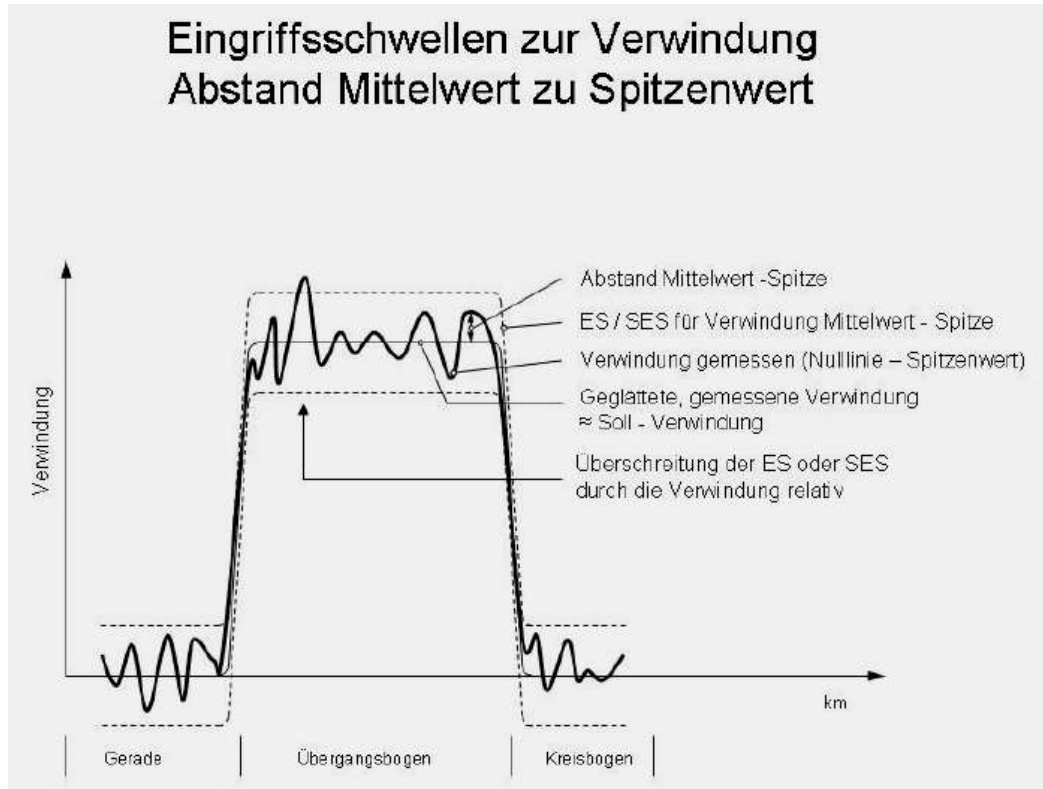
Abbildung 33 Darstellung der ES/SES der Verwindung Mittelwert zu Spitzenwert (DB IS2-T1) - Quelle IM
