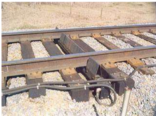
Abbildung 71 Ortfester Entgleisungsdetektor - Quelle Safety Board of Canada
