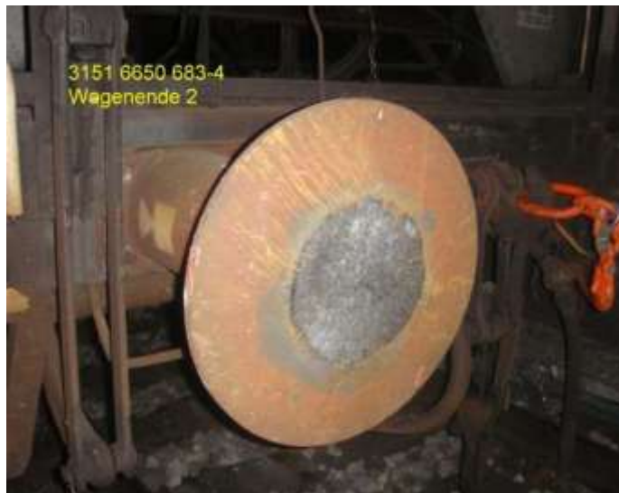
Abbildung 23 7. Wagen - trockener und verrieftter Pufferteller - Quelle IM
