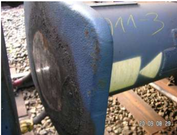
Abbildung 26 21. Wagen - trockener und verrieftter Pufferteller - Quelle IM
