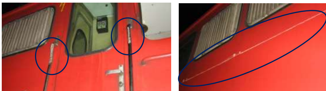
Abbildung 15 Kollisionsspuren am Tzf Z 753 (vorne und mittig) - Quelle IM
