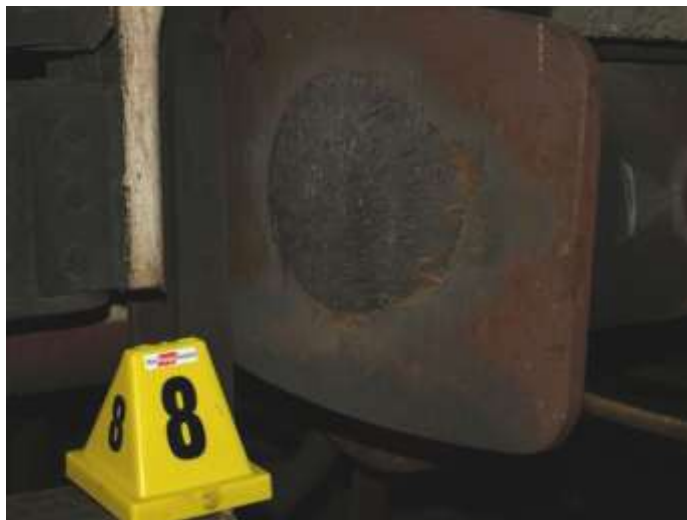
Abbildung 21 6. Wagen - trockener und verrierter Pufferteller - Quelle RU
