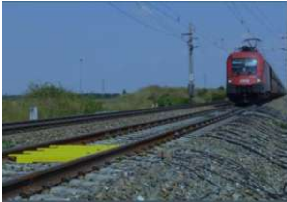
Abbildung 66 Ortfester Entgleisungsdetektor - Quelle Argos Systems
