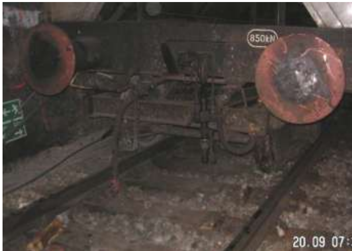
Abbildung 20 5. Wagen - trockener und verrierter Pufferteller - Quelle RU
