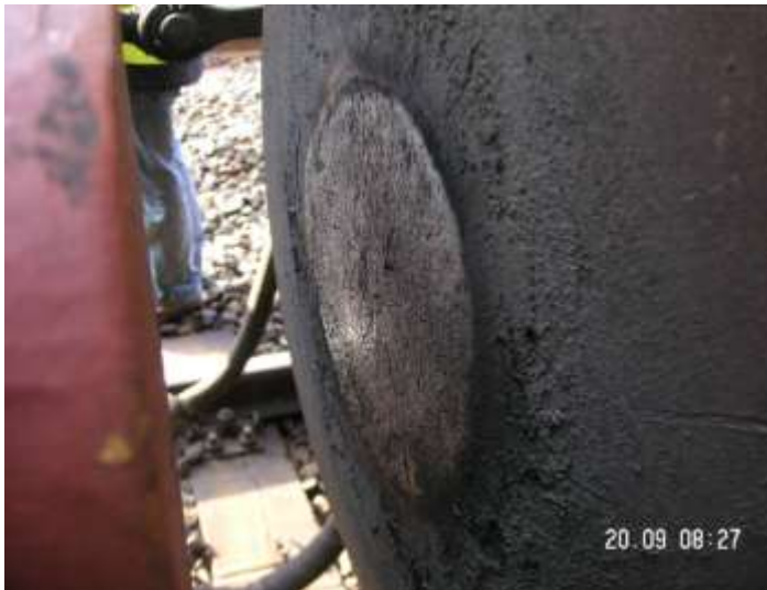
Abbildung 25 19. Wagen - trockener und verrieftter Pufferteller - Quelle IM
