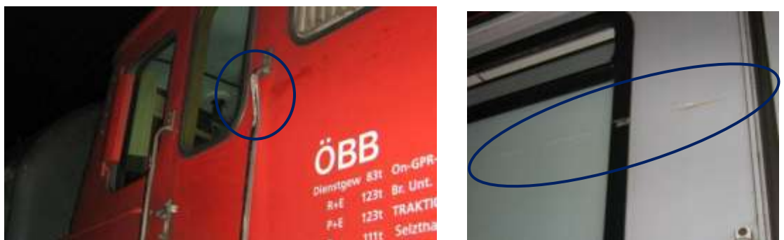
Abbildung 16 Kollisionsspuren am Tzf Z 753 (hinten) und am 1. Reisezugwagen- Quelle IM
