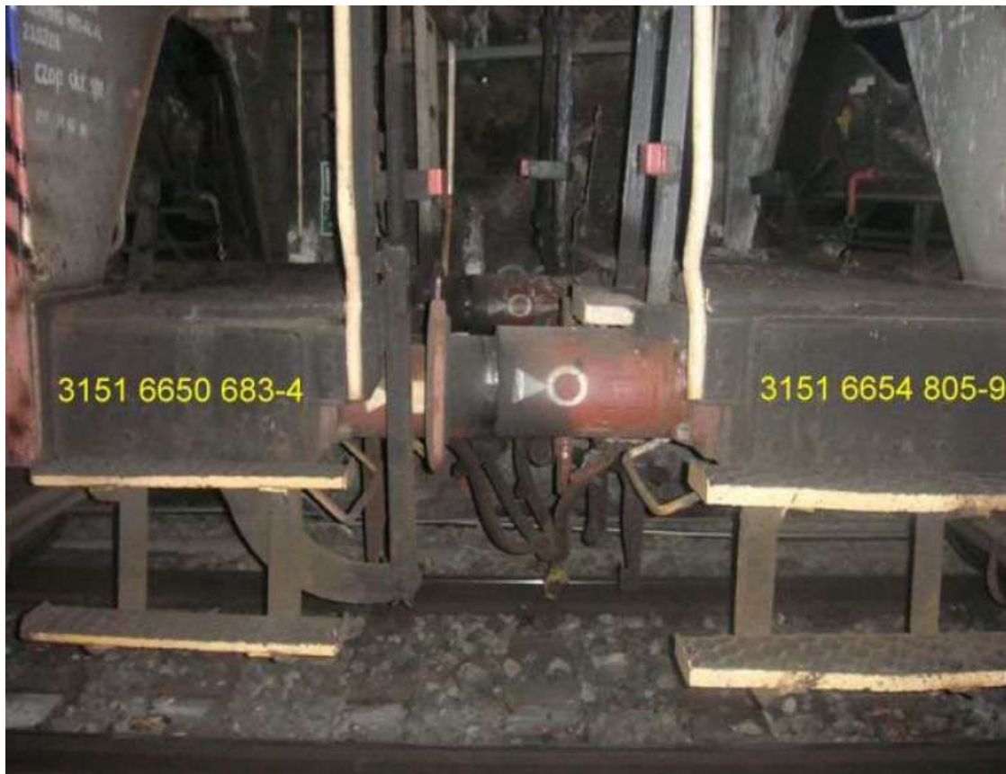
Abbildung 14 Überpufferte Wagen (7. und 6. Wagen) - Quelle IM
