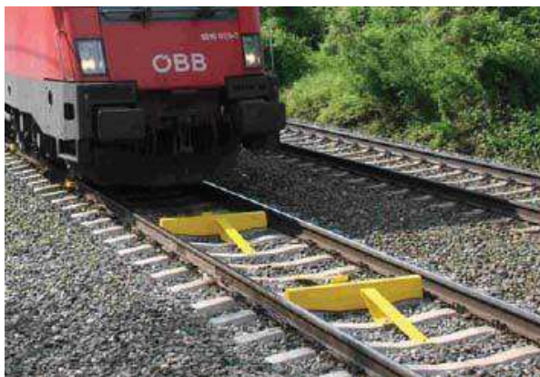
Abbildung 68 Ortfester Entgleisungsdetektor - Quelle Thales
