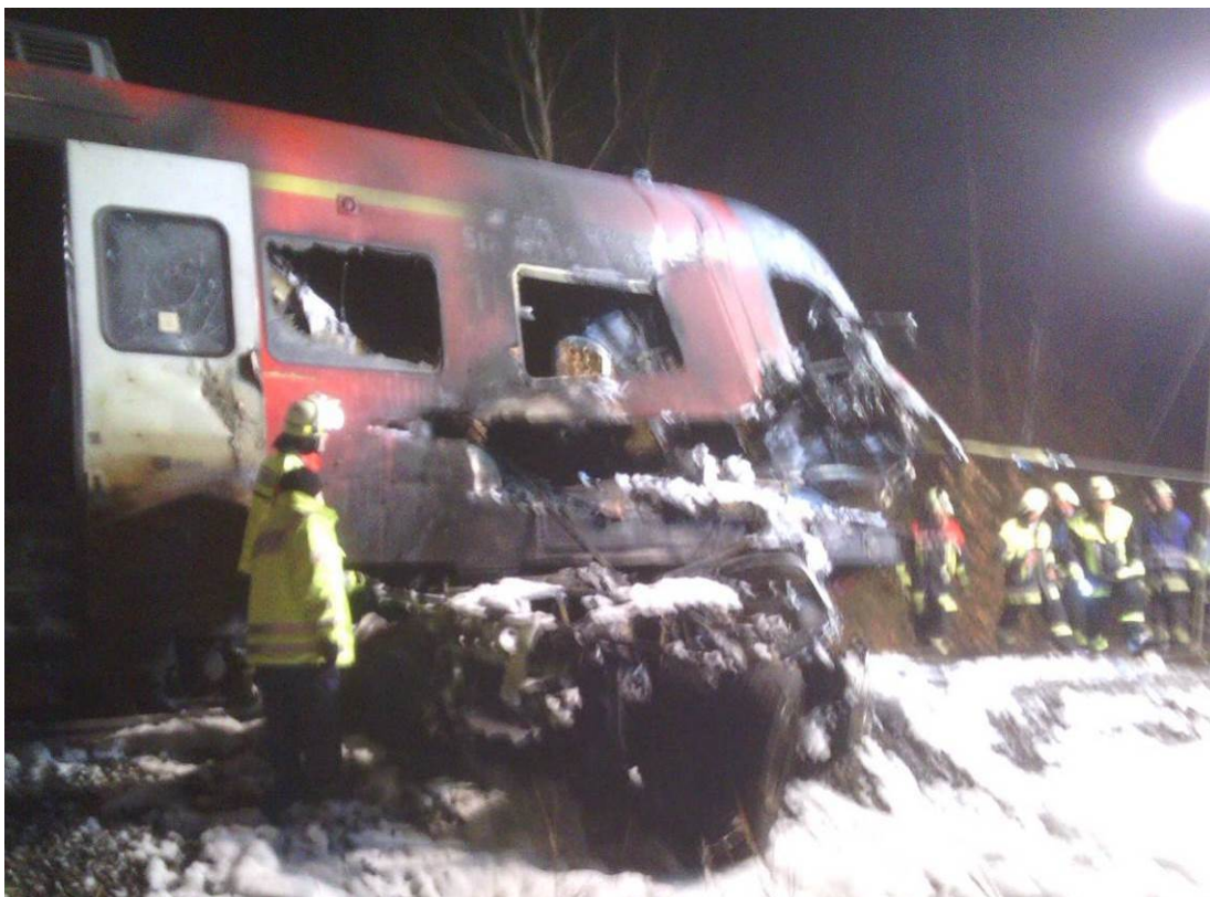
Abb. 2: Triebwagen mit verkeiltem Fahrgestell der Sattelzugmaschine
