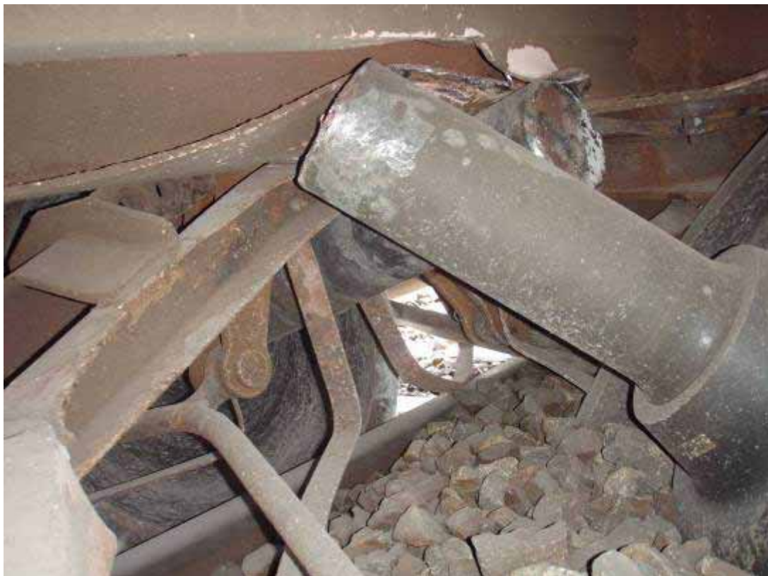
Abbildung 11 Gebrochene Radsatzwelle des Wagens 31 80 069 5 108-7
