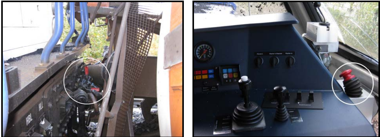
Abb. 13: Tfz 203 162, Luftabsperrhahn und Schlagschalter
