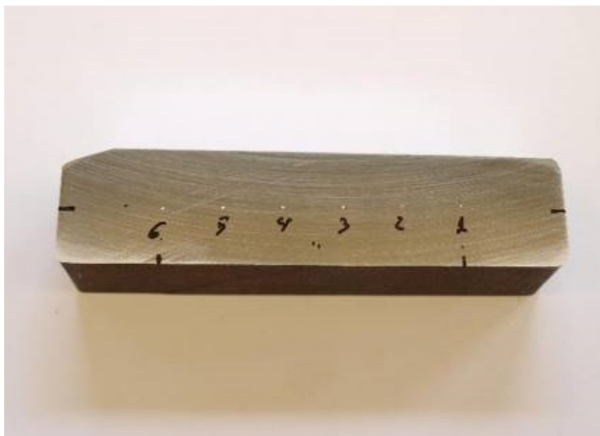
Probeta extraída del patín de la punta móvil del corazón sometida al ensayo de dureza
