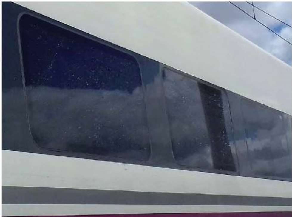
Detalle de daños ocasionados al tren 0043 por el descarrilamiento. Fuente Adif
