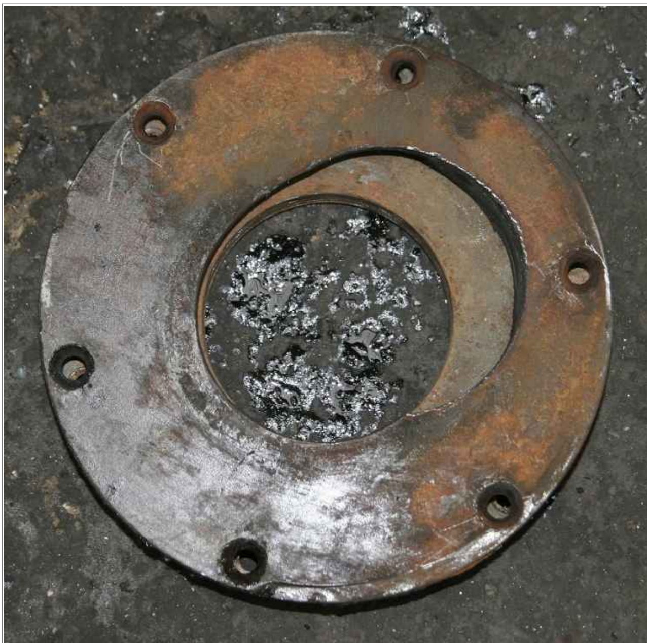
Obr. č. 10: Porovnání poškozeného levého víka ložiskové skříně 1. nápravy zadního podvozku DV MTV, ev. č. 1313, přiložením k novému víku ložiskové skříně nápravy podvozku KOMFORT.
