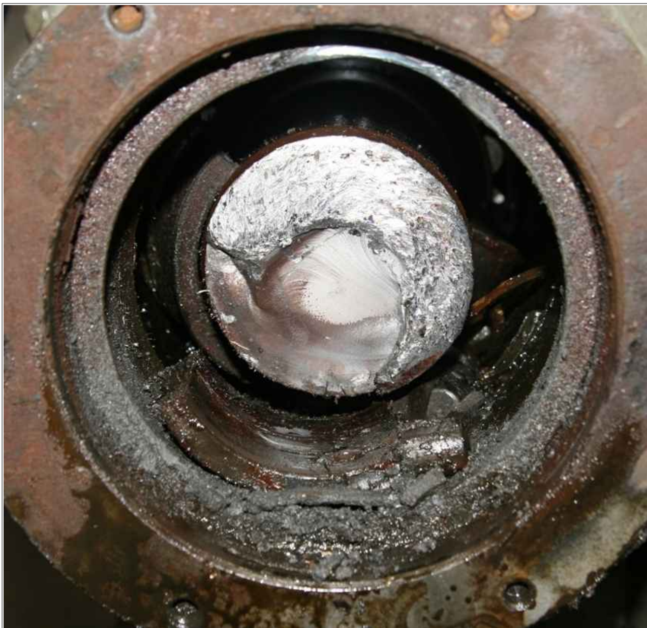
Obr. č. 7: Levá část převodové skříně (tzv. nohavice) s porušeným nápravovým ložiskem 1. nápravy zadního podvozku DV MTV, ev. č. 1313.
