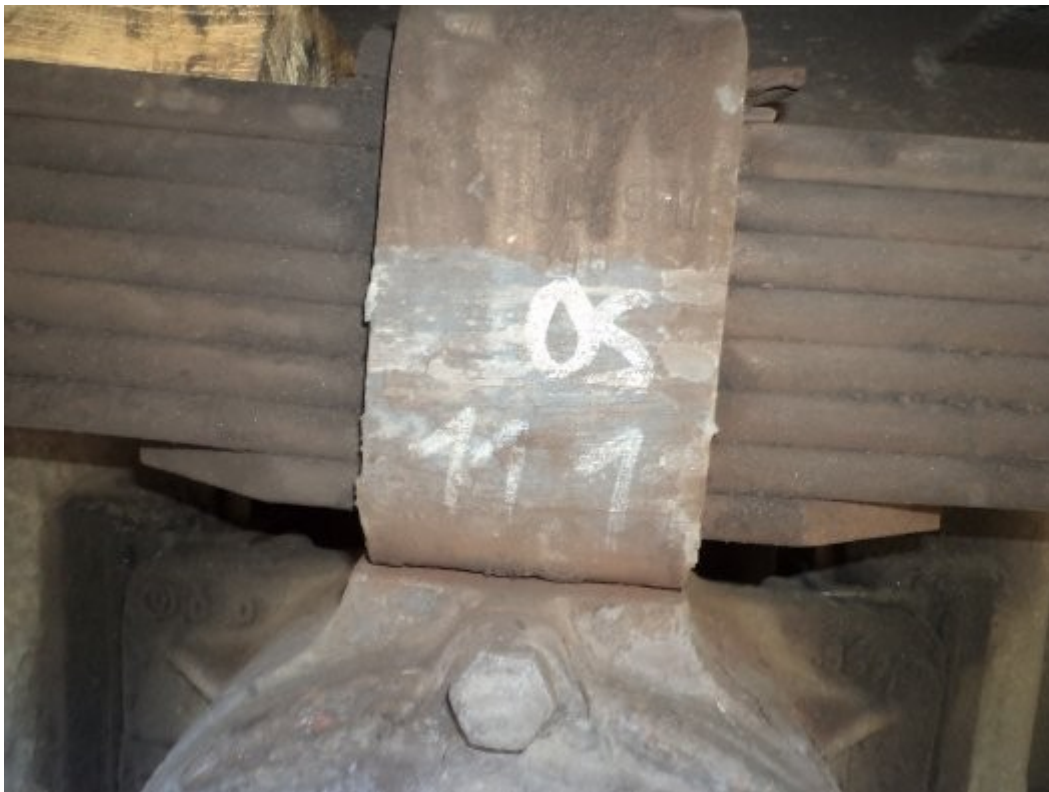
Obr. č. 9: Vyznačení defektoskopické kontroly na pružnici
