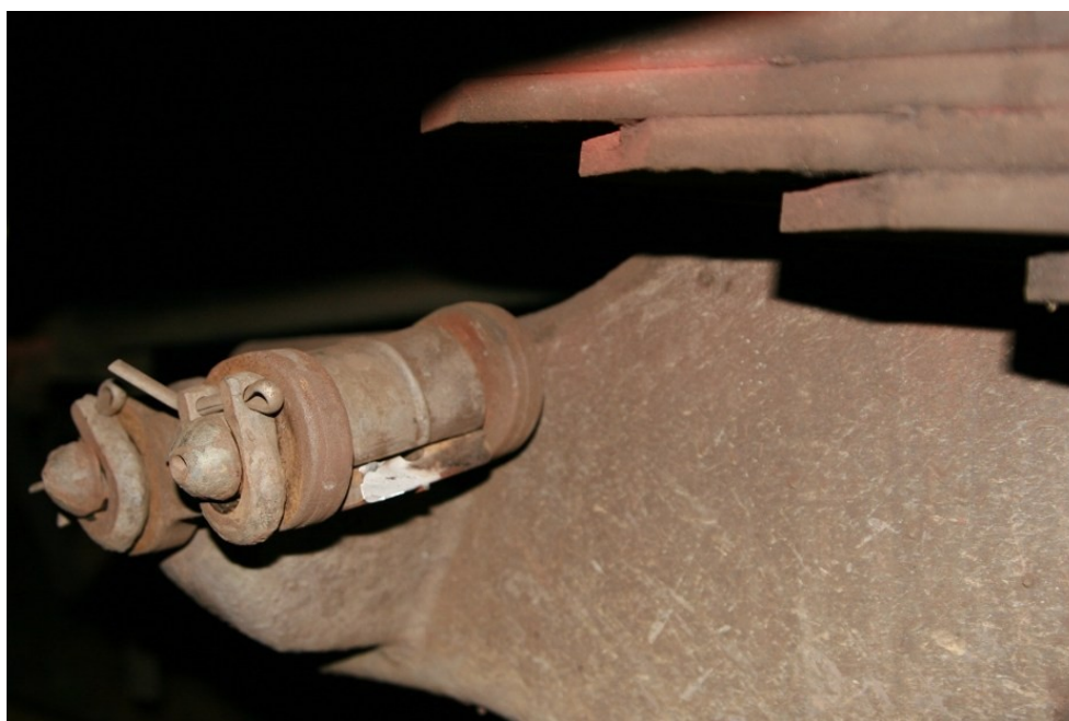
Obr. č. 3: Detail zlomeného hlavního listu pružnice
