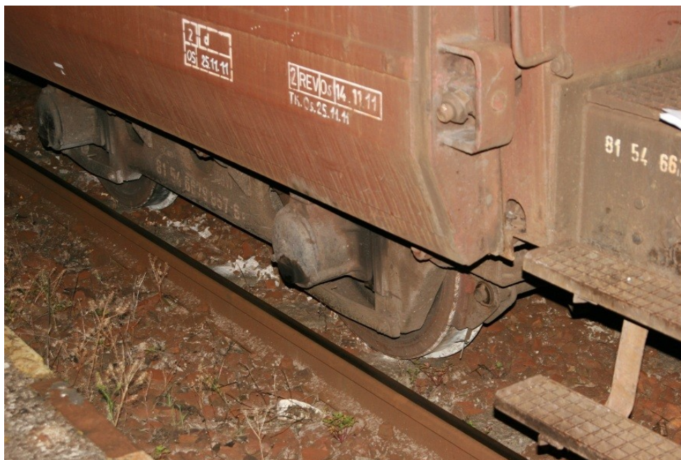
Obr. č. 1: Vykolejený podvozek "a" vykolejeného vozu Falls č. 81 54 6679 867-6, vyznačení provedení technické kontroly na voze
