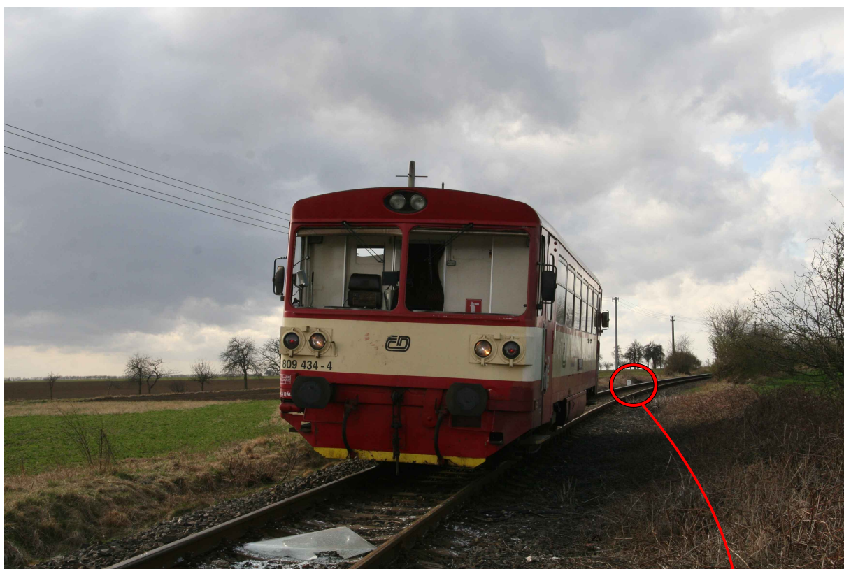
Foto 3: pohled na HDV PMD, střepy čelních oken leží v místě nárazu
