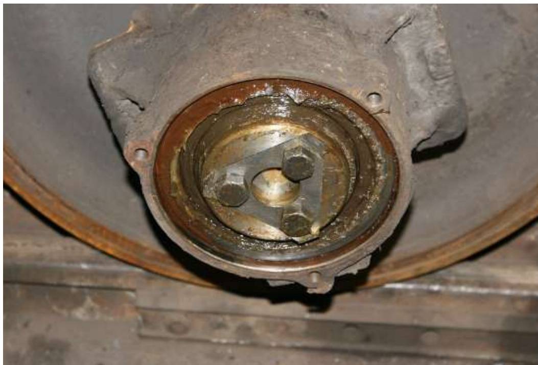
Obr. č. 8: Stav jedné z ostatních ložiskových komor TDV nezasážené nehodovým dějem Zdroj: DI
