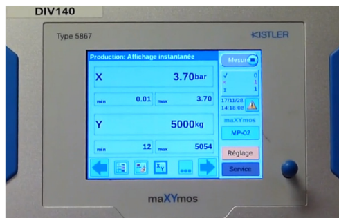
Affichage du banc de test de la valve de pesée : la valve étant de type 3, elle devrait «sortir» 4 bar si une charge de 5 tonnes lui est appliquée. Sur le banc de mesure, 3,7bar sont mesurés (valve endommagée).
