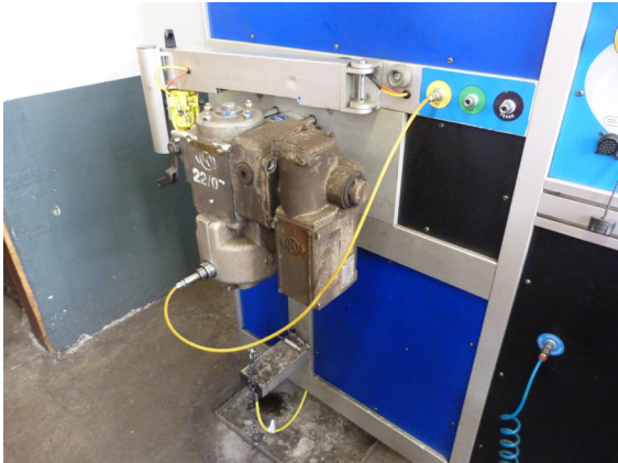
Banc de mesure sur lequel est monté le distributeur à mesurer/tester.
