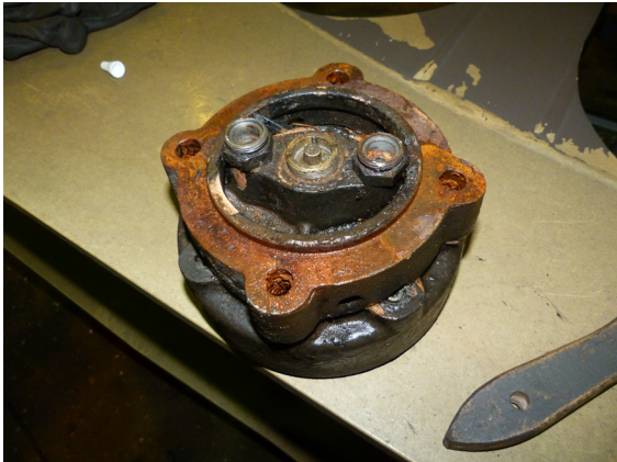
Valve de pesée démontée du bogie 3-3' du wagon 33 68 4952 072-9.
