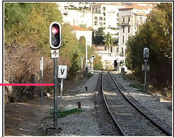
Le signal d'arrêt n°1 avant la pancarte « V » d'entrée en zone de gare
