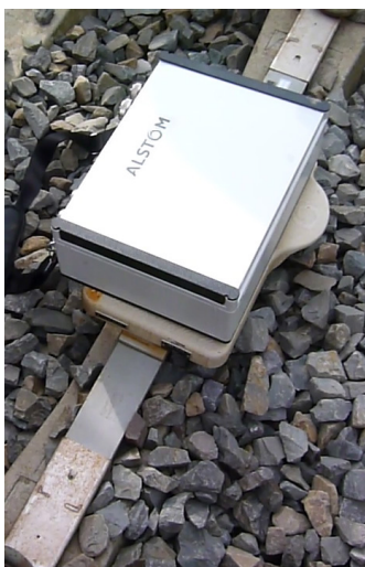
Equipement de test placé sur une balise TBL1+.
