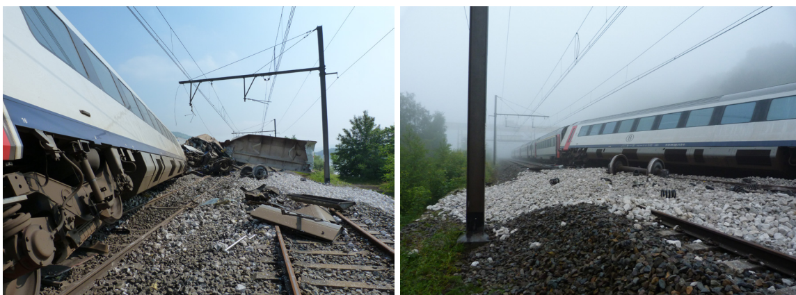
Illustrations : la deuxième voiture de la rame 548 est déraillée mais pas complètement couchée sur les voies.
