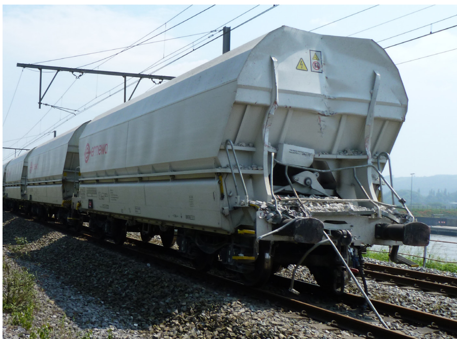
Illustration : queue du train E48535 (avant dernier wagon, endommagé lors de la collision)
