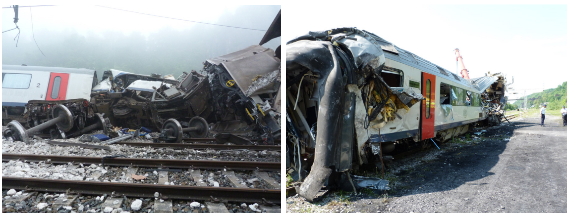
Illustrations : la voiture de tête de la rame 548 est couchée sur les voies et encastrée dans les débris du wagon de queue du train de marchandises.
