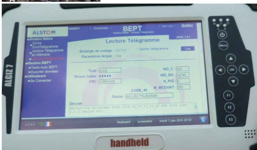
Illustration : équipement (tablette) permettant de lire le télégramme émis par une Eurobalise.
