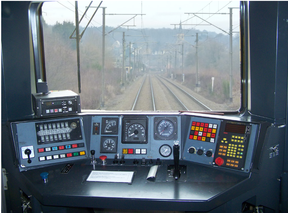
Afbeelding: zicht op de volledige bestuurderspost van een MS96.
