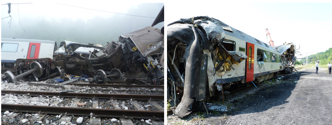
Afbeeldingen: het koprijtuig van stel 548 ligt neer op de sporen en is verstrengeld in de restanten van de startwagon van de goederentrein.
