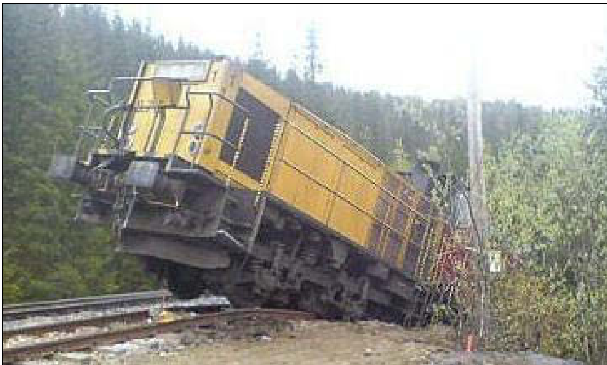
Figur 2: Det avsporede lokomotivet etter at det hadde kjørt gjennom endebuttstokken.
