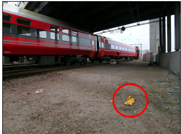
Figur 4: Viser bufferplaten som ble kastet ut til høyre side, rett ut for avspøringsstedet.
