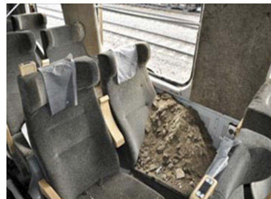
Figur 11: Viser jord og leire som er presset inn i kupeen gjennom vindusåpningen.
