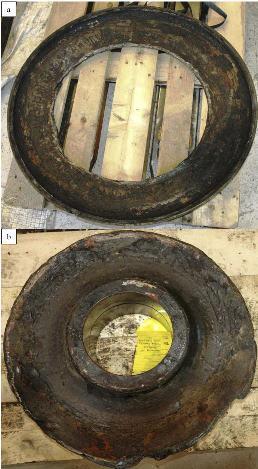
Figur 1 Oversiktsbilde av havarete toghjul.
