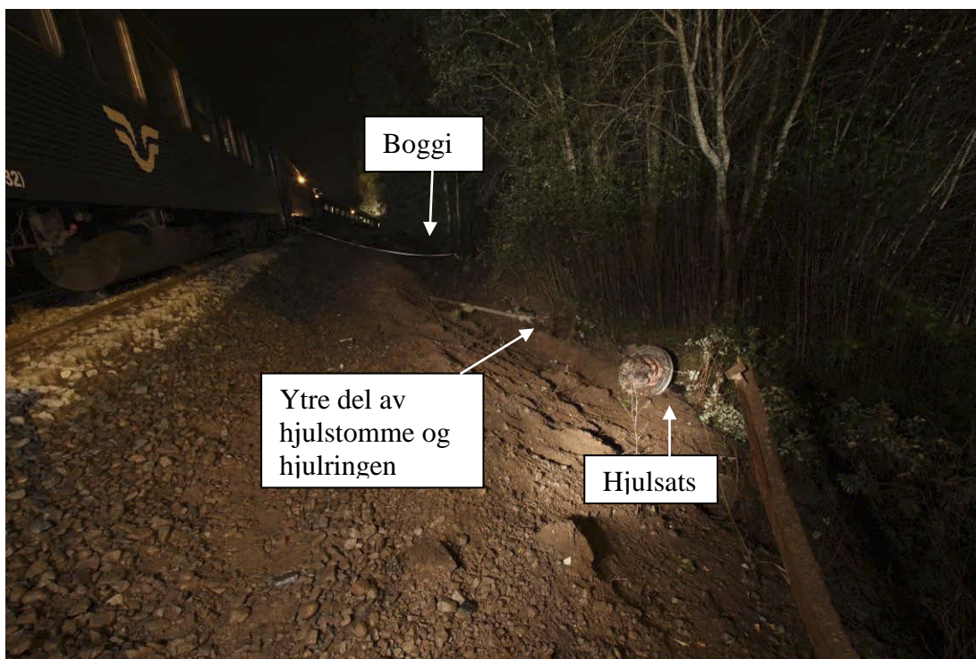
Figur 6: Viser hvor hjulsats fra bakre boggi, vogn 1 ble funnet.
