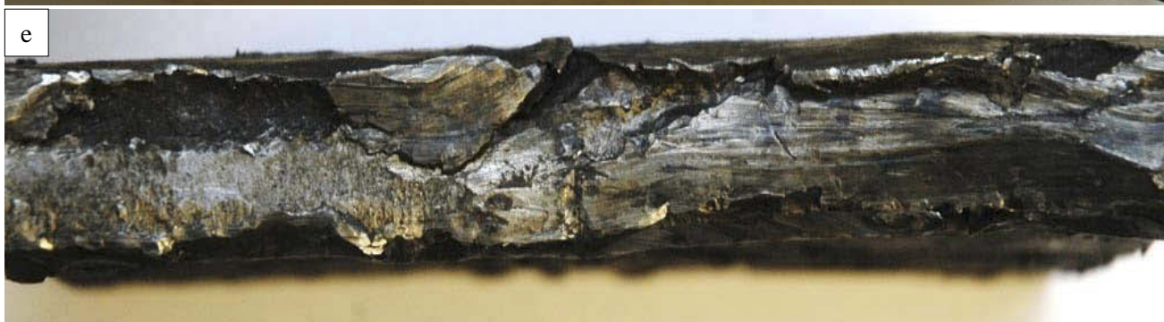
Figur 4 a-e Oversiktsbilder av bruddflater kappet ut fra havarett hjul som angitt i Figur 3.
