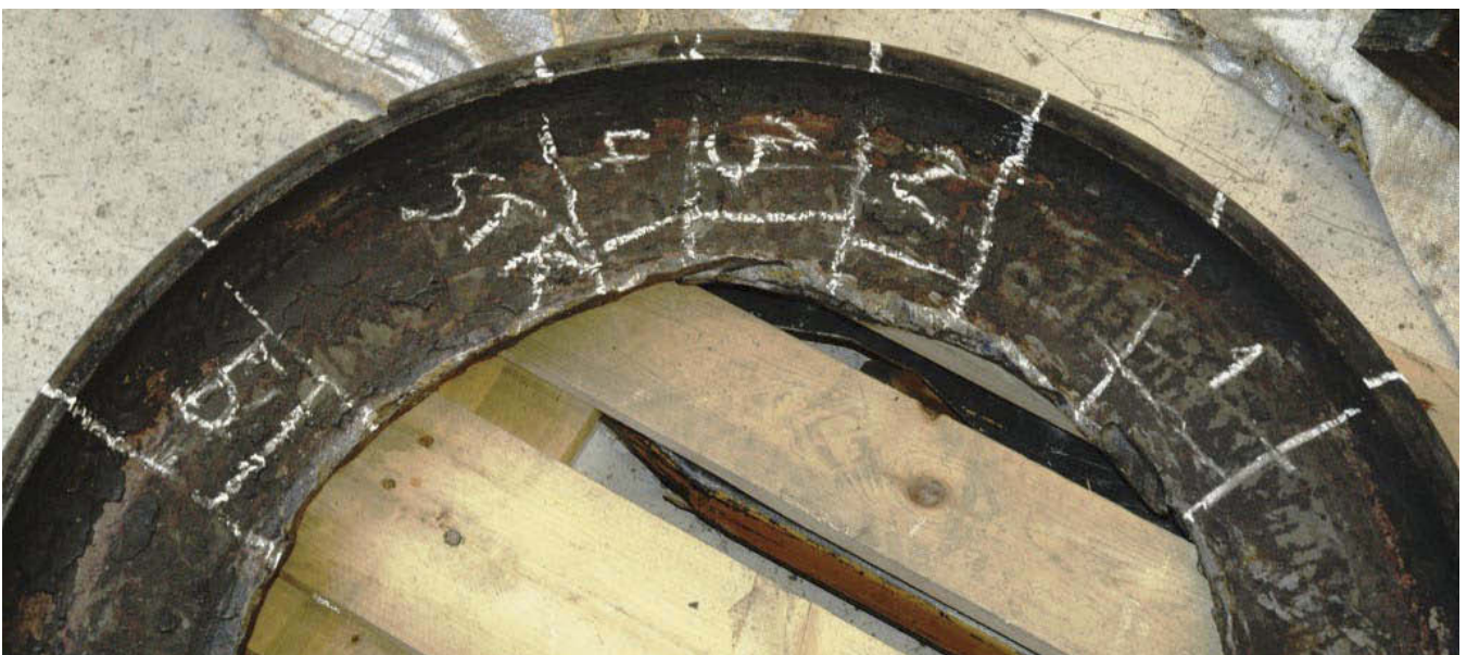
Figur 3 Oversiktsbilde av prøveuttak. 1-5 angir område med synlig original bruddflate og STR angir område for uttak av prøvestykker for strekkprøving.
