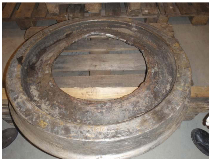
Figur 16: Ytre del av hjulstomme og hjulring.
