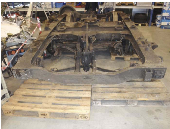
Figur 18: Boggirammen til hjulet som gikk til brudd.
