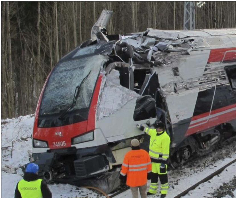
Figur 26: Fronten med synlige forsterkninger (foto: SHT).
