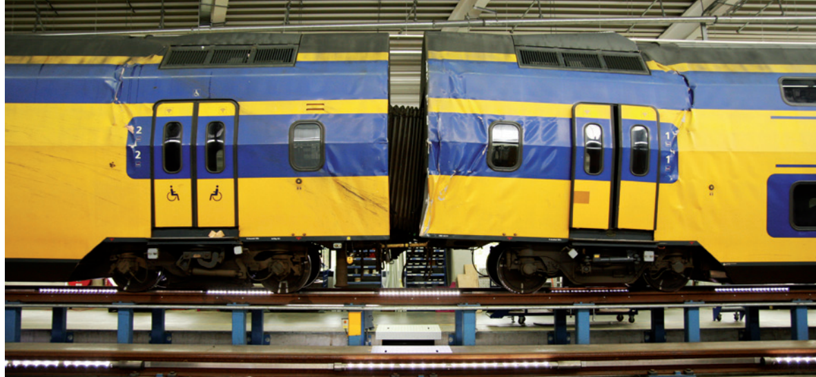
Van de intercity raakten de uiteinden van de rijtuigen vervormd. Bij de sprinter was dat niet het geval.
