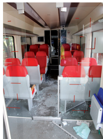
Schade in het interieur van beide treinen. Geheel links: beschadigingen aan de achterzijde van stoelen in de intercity. Links: gebroken glazen paneel in de intercity. Rechts: gebroken tussendeur in de sprinter. Geheel rechts: de schade aan een glazen paneel in de sprinter.
