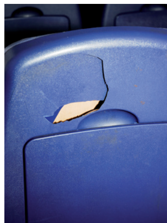
Schade in het interieur van beide treinen. Geheel links: beschadigingen aan de achterzijde van stoelen in de intercity. Links: gebroken glazen paneel in de intercity. Rechts: gebroken tussendeur in de sprinter. Geheel rechts: de schade aan een glazen paneel in de sprinter.
