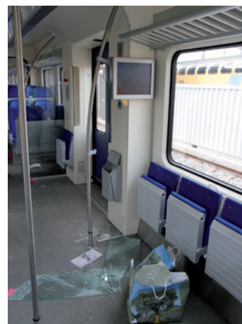
Schade in het interieur van beide treinen. Geheel links: beschadigingen aan de achterzijde van stoelen in de intercity. Links: gebroken glazen paneel in de intercity. Rechts: gebroken tussendeur in de sprinter. Geheel rechts: de schade aan een glazen paneel in de sprinter.
