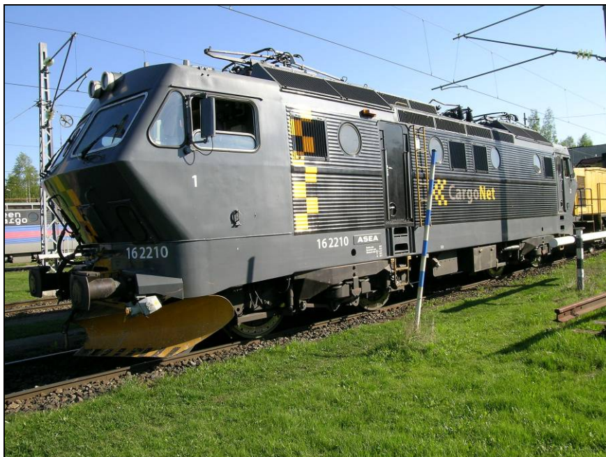
Figur 1. Det var minimalt med synlige brannskader utvendig på lokomotivet.
