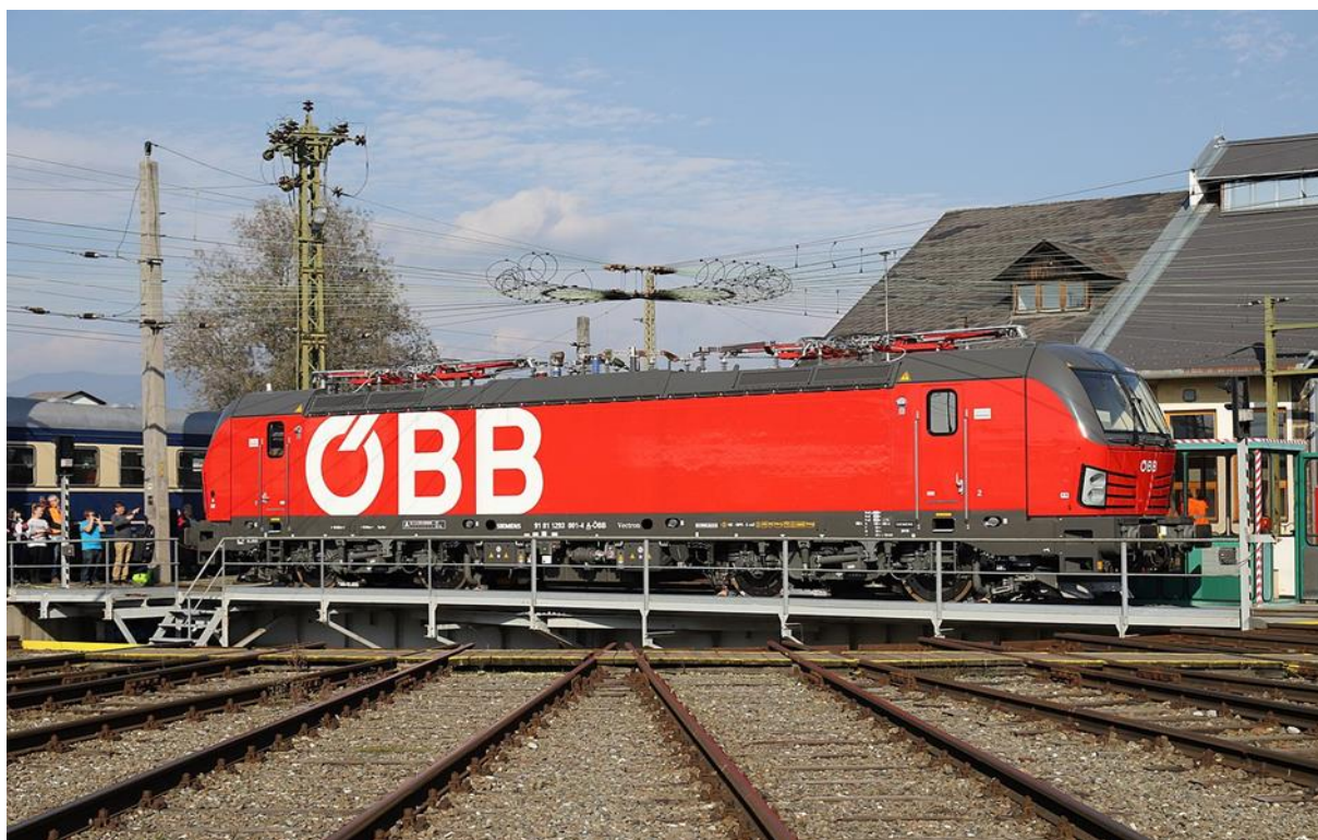
Slika 3. Lokomotiva Siemens Vectron serije 1293 (Izvor slike: Wikipedia)
