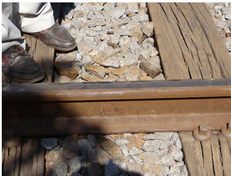
Foto 3 – Marca produzida pela roda, ao cair do carril
