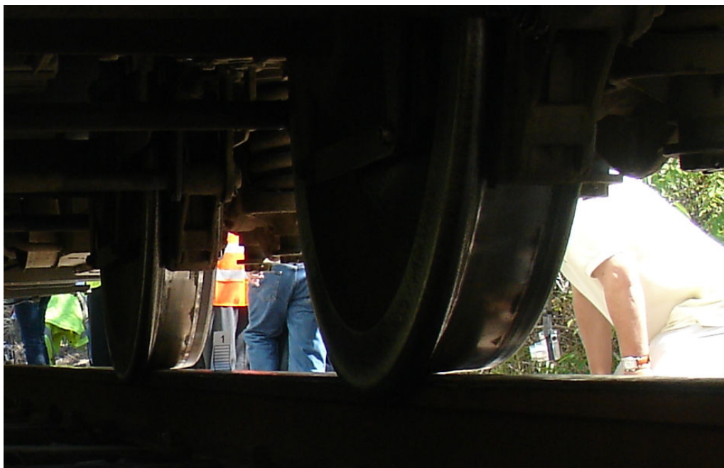
Foto 4 – Roda de guiamento não apoiada na mesa de rolamento do carril
