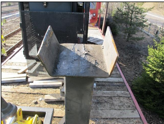
Figur 7: Holdebraketten for kranarmen er bøyd. Foto: SHT
