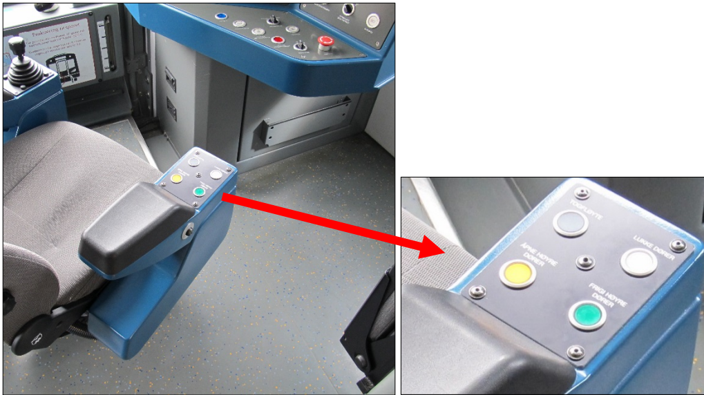
Figur 11: Åpne- og frigivningsknapp for dører, plassert på førerstol. Foto: SHT
