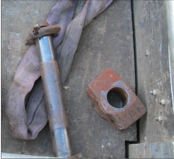
Figur 17: Eksempel på hel bolt, klave med låsesplint og mellomstykke. Foto: SHT
