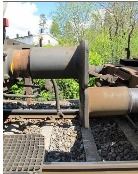
Figur 4: Avsporet vogn kilt inn under buffere til tankvogn foran. Foto: SHT
