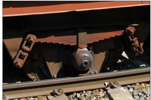
Figur 27: Understykkets posisjon i forhold til skinne ved bakre venstre hjul. Foto: SHT
