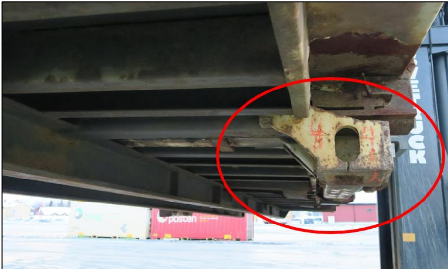
Figur 14: Containerhjørne på vekselbeholder med Lagab-ben sett fra siden. Foto: SHT
