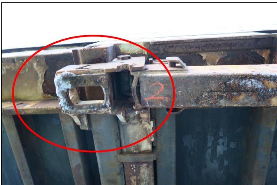
Figur 13: Containerhjørne på vekselseholder med Lagab-ben. Foto: SHT
