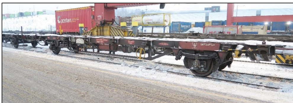
Figur 10: 2-akslet containervogn Lgns 4432. Foto: SHT
