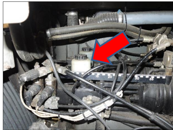
Figur 7: Tom bremsevæskebeholder. Foto: SHT
