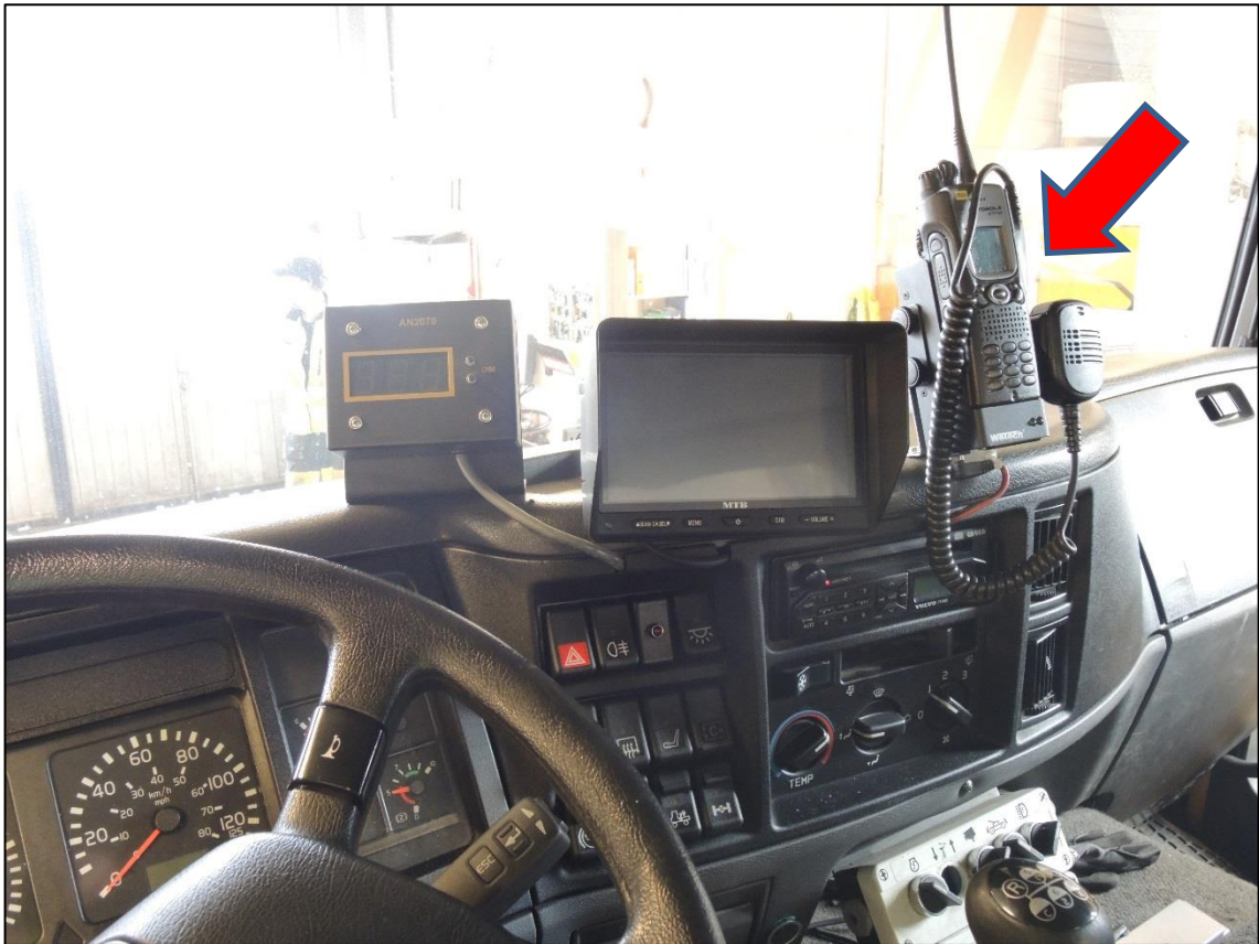
Figur 19: Plassering av radio i ledningsbilen. Foto: SHT
