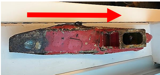
Figur 9: Oversiden av skadet bremsesko. Pilen viser fartsretningen. Foto: Bane NOR
