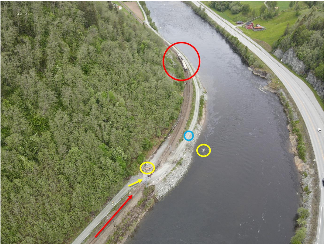
Figur 2: Oversiktsfotografi av ulykkesstedet. Gul pil viser traktorens kjøreretning. Gule ringer viser traktorens plassering i elven og tilhengerens plassering til venstre ved signalkiosken. Føreren ble funnet ved den blå ringen. Rød ring viser togsettets plassering etter ulykken. Foto: Politiet. Påtegninger: Statens vegvesen
