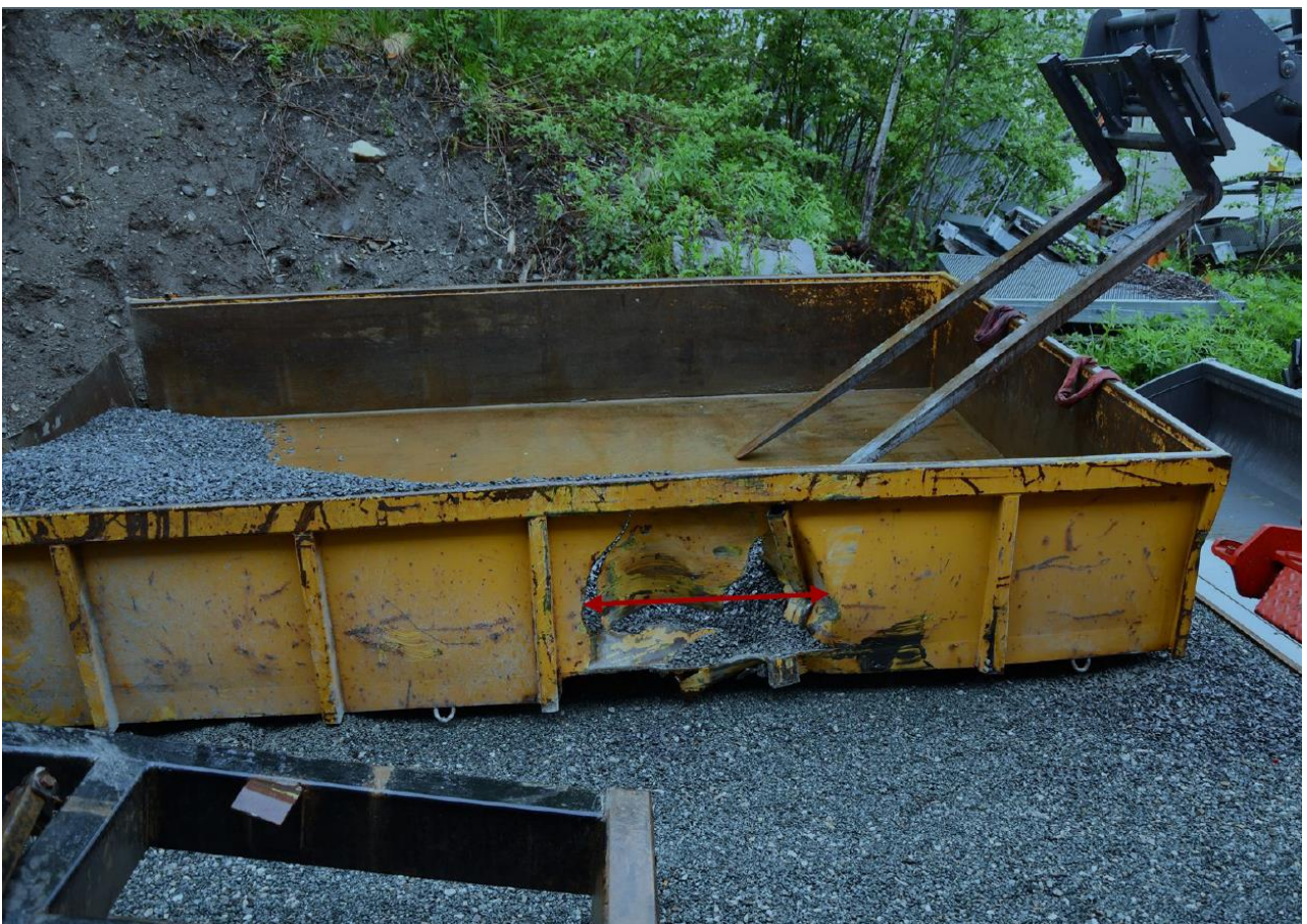
Figur 12: Traktortilhengerens tilhengerkasse med merke etter togets venstre buffer. Foto og markering: Statens vegvesen
