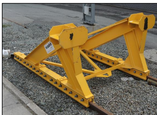
Figur 9: Fastmontert endebutt montert i spor 23 etter ulykken. Foto: SHT
