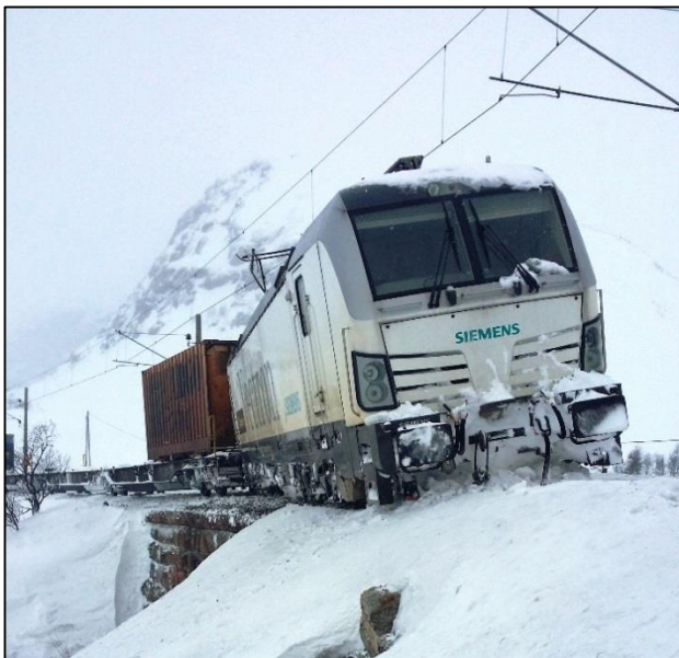
Figur 2: Avsporet lokomotiv. Foto: Jernbaneverket
