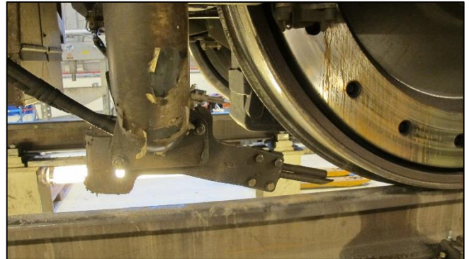
Figur 14: Bilde skinnerydder. Foto: SHT
