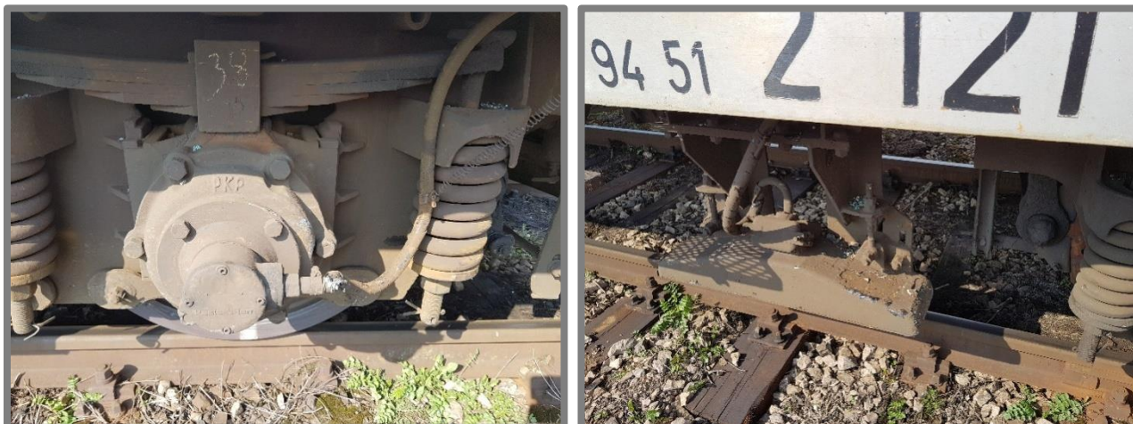
Uszkodzenia w elektrycznym zespole trakcyjnym seri EN57-1292 po wypadku
