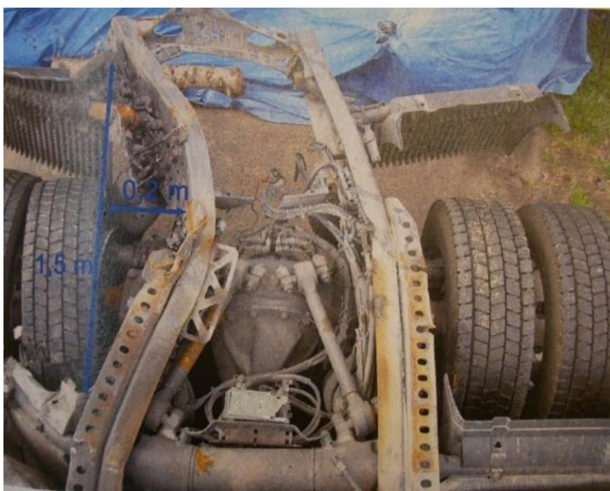
Fot.24. Uszkodzenia ciągnika siodłowego, ślady uderzenia od zestawów kołowych pociągu
