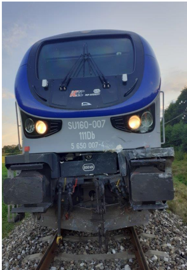
Zdjęcie 6. Widok czoła lokomotywy po zderzeniu z samochodem - materiał Zespołu badawczego
