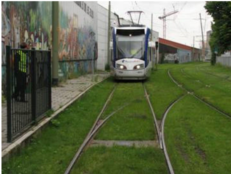
Figuur 12- Voertuig nadert een klapwissel
