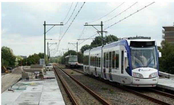
RandstadRail voertuig van HTM: lage vloertram
