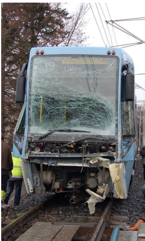
Figur 2: Fronten på vogn 153 etter sammenstøtet.
