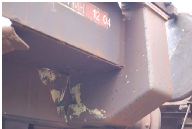
Figur 2: Skader på bakre del venstre side av sidebjelke på vogn 4076 943 1033-1
