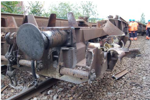
Figur 1: Skader i front venstre side på vogn 4076 943 1033-2
