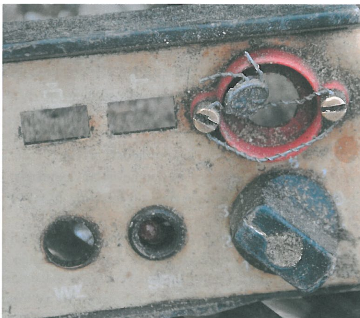
Fot. III.4.3) Fragment płyty czołowej manipulatora radiotelefonu z kabiny A lok. ET22-1105 (mat. Prok. Okr. Częstochowa)
