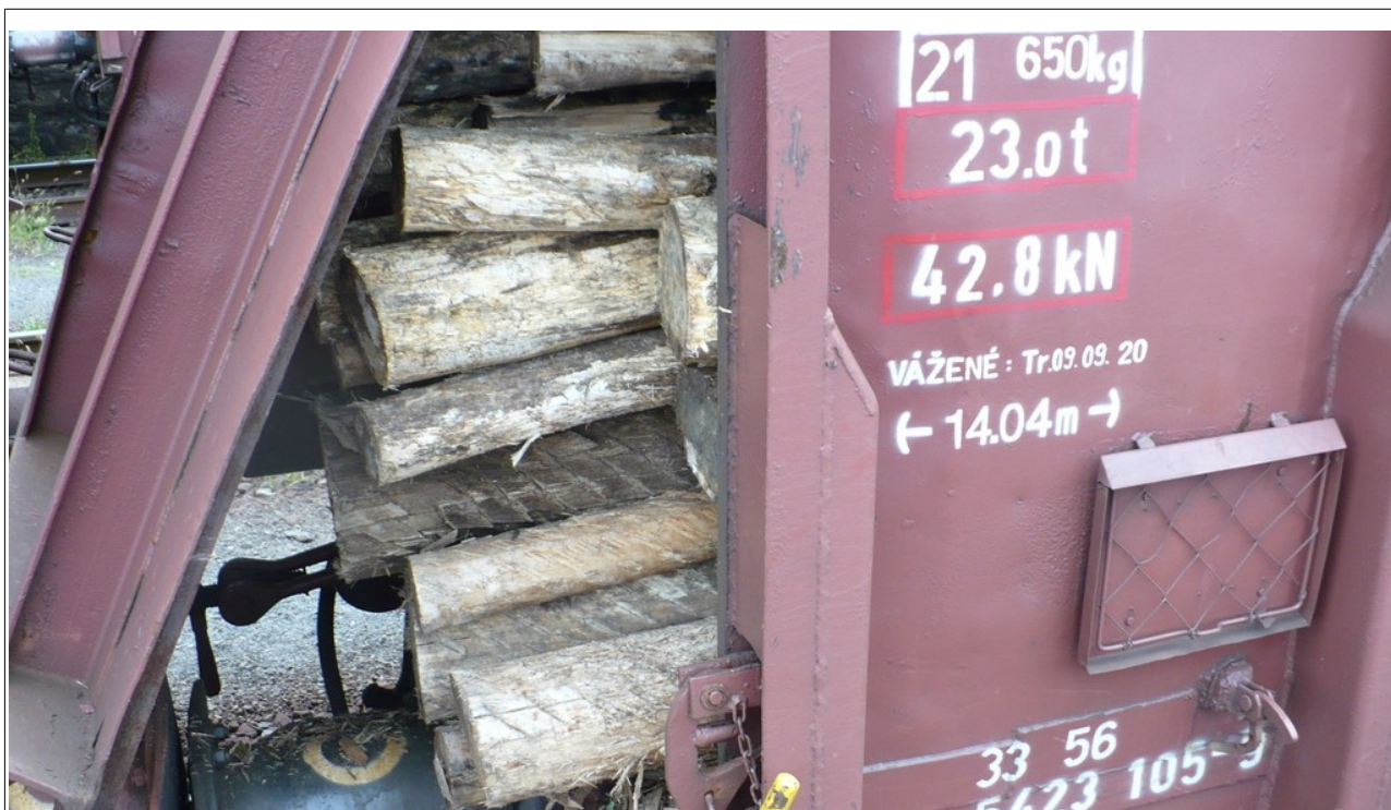
Obr. č. 6: Poškození TDV č. 33 56 5423 105-9 a posunutí jeho nákladu po zastavení vlaku Pn 55077 v žst. Třinec Zdroj: SŽ
