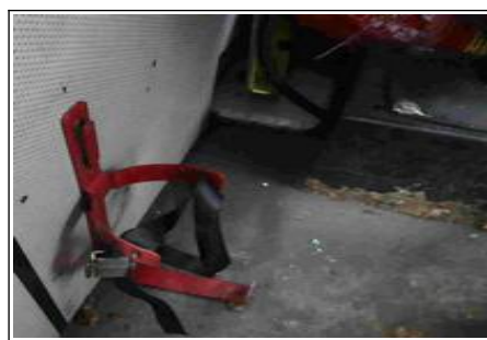
Figure 50 : dispositifs de fixation des extincteurs dans la cabine de conduite de la locomotive accidentée
