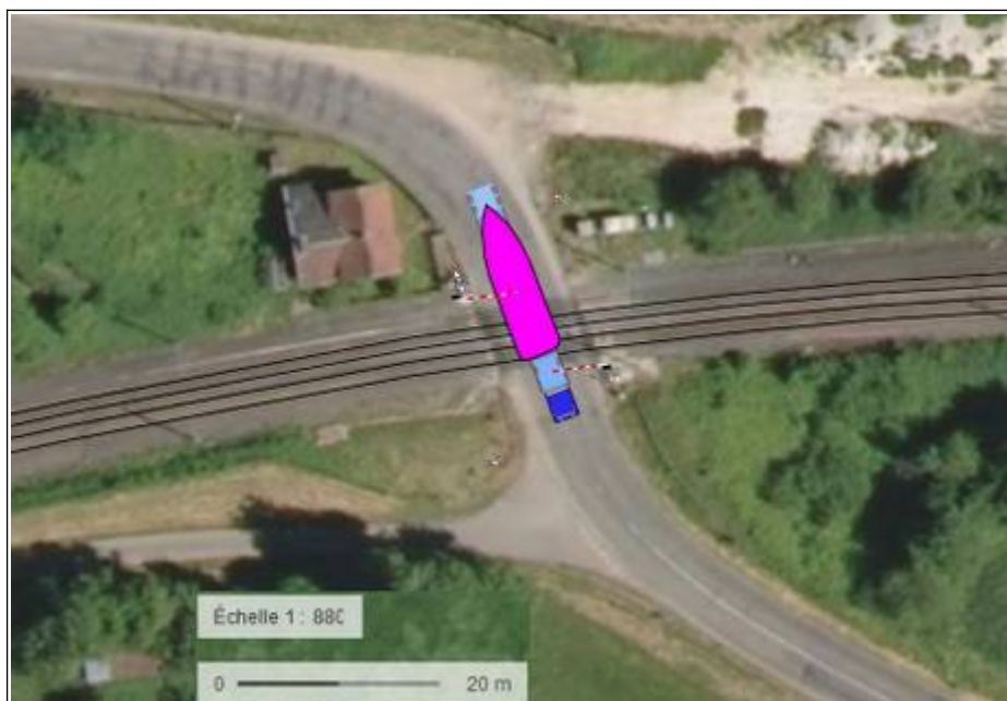
Figure 38 : situation de blocage du convoi peu avant le choc
