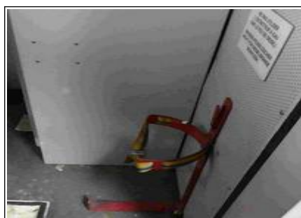
Figure 50 : dispositifs de fixation des extincteurs dans la cabine de conduite de la locomotive accidentée
