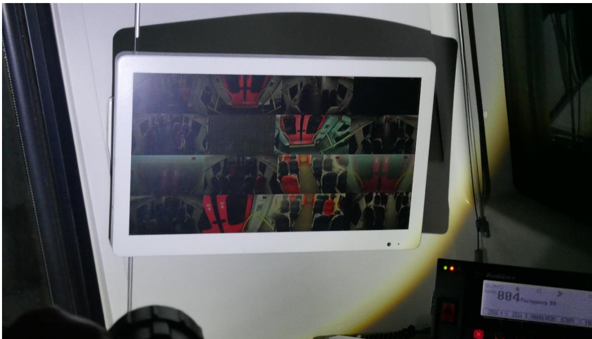
Zdjęcie 8 - Kabina maszynisty wyposażona w podgląd z kamer przemysłowych (materiał własny PKBWK).
