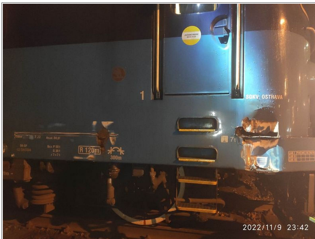
Obr. č. 6: Poškození HDV vlaku Nex 55530
