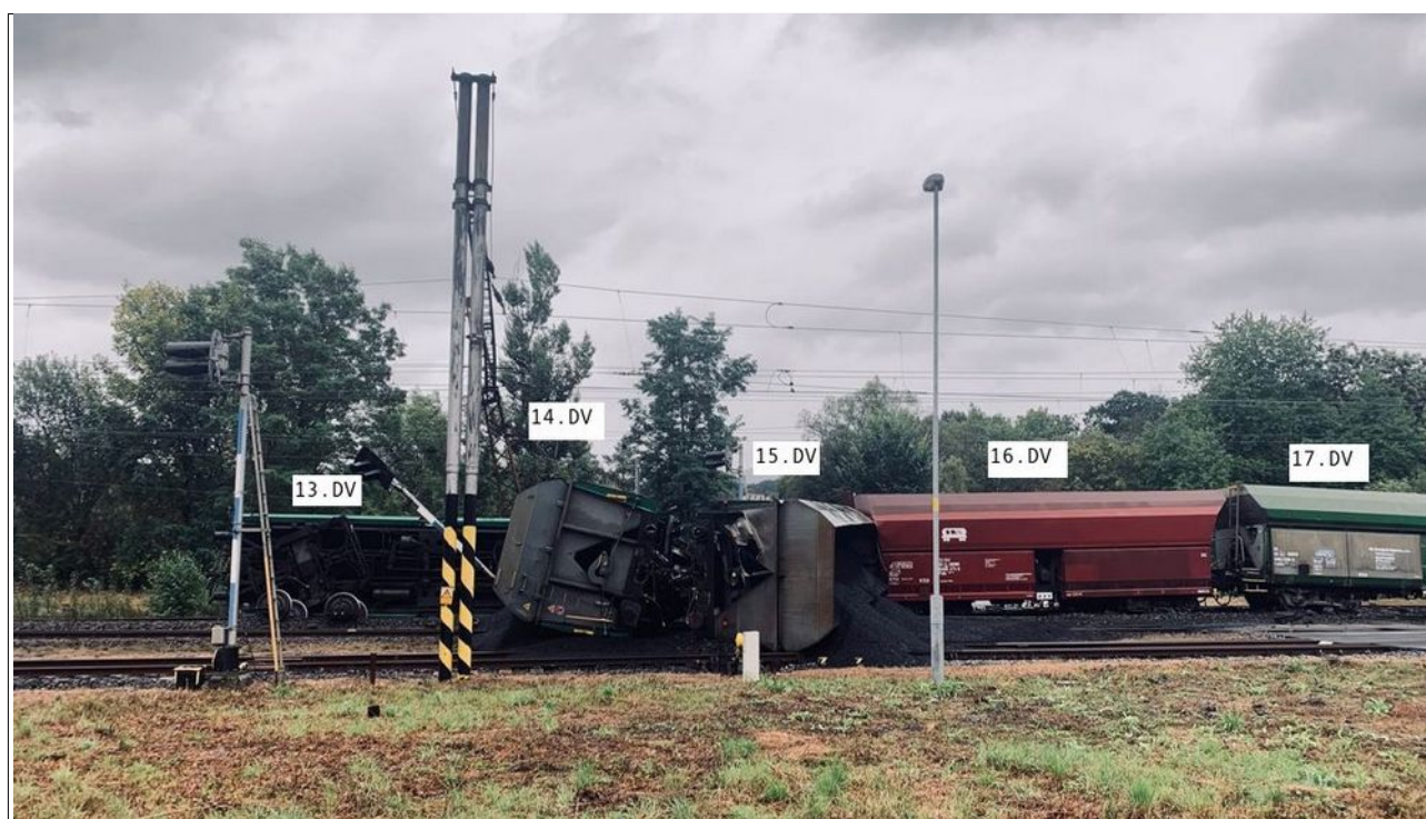
Obr. č. 7: Pohled na vykolejená DV
