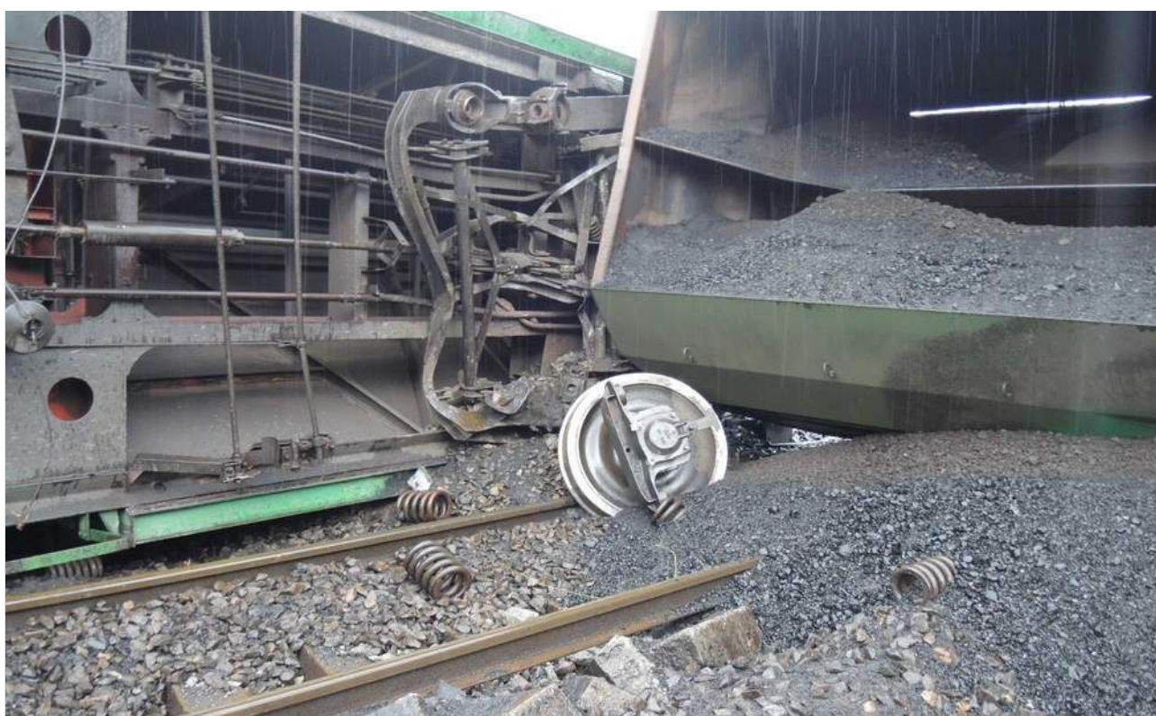
Obr. č. 9: Pohled na vykolejená a převrácená DV a součásti pojezdu
