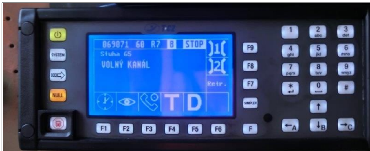
Obr. 2: Stav radiostanice na HDV
