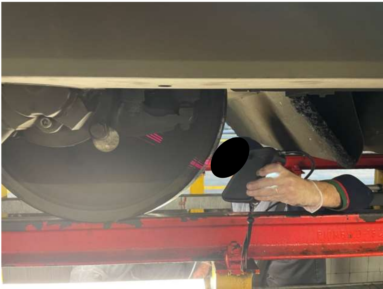
Figura 20 - Attività di misura dei profili delle ruote (fonte immagine: Ufficio; elaborazione: Ufficio).
