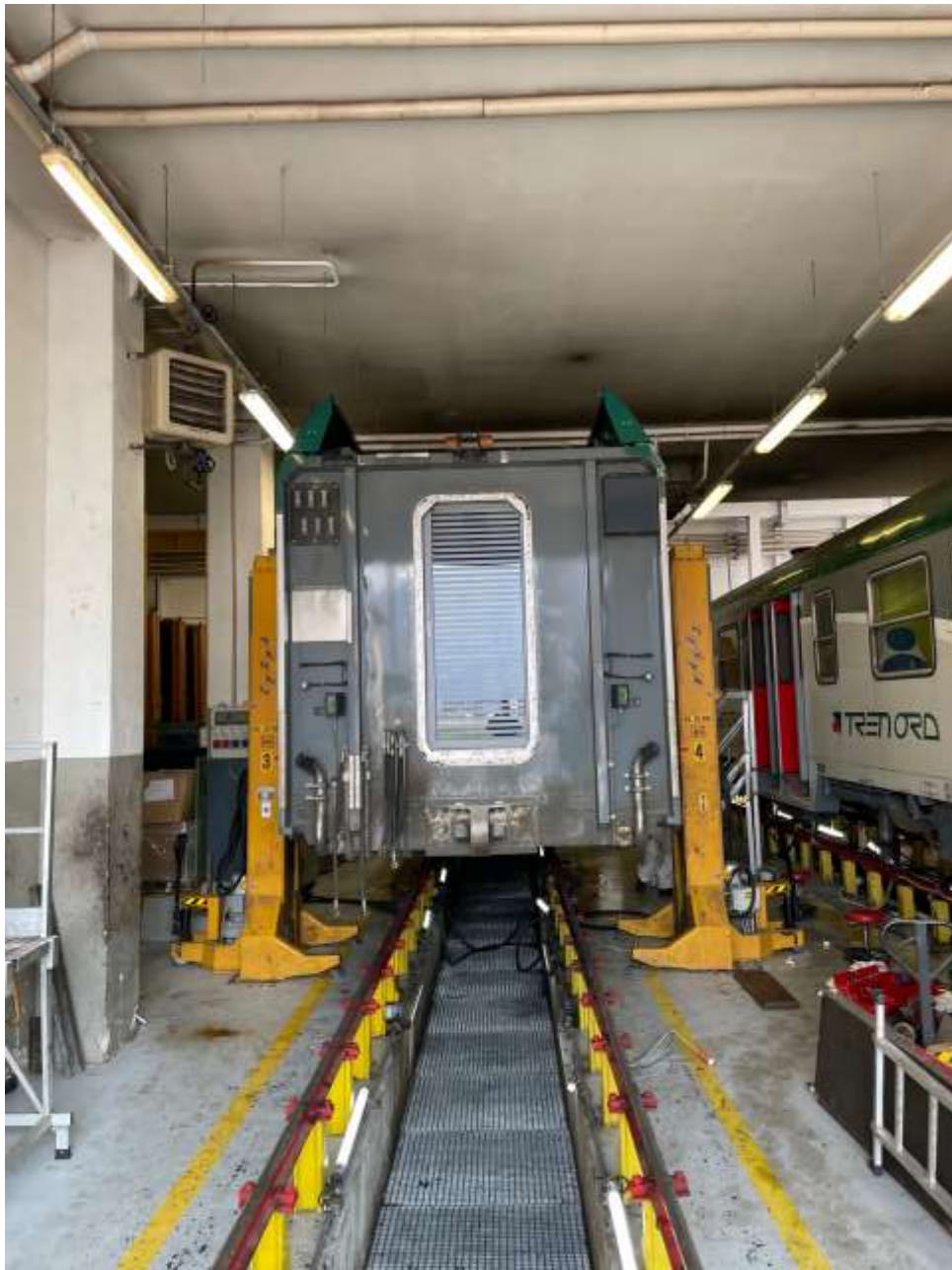
Figura 21 – Sollevamento della cassa per ispezione (fonte immagine: Ufficio).
