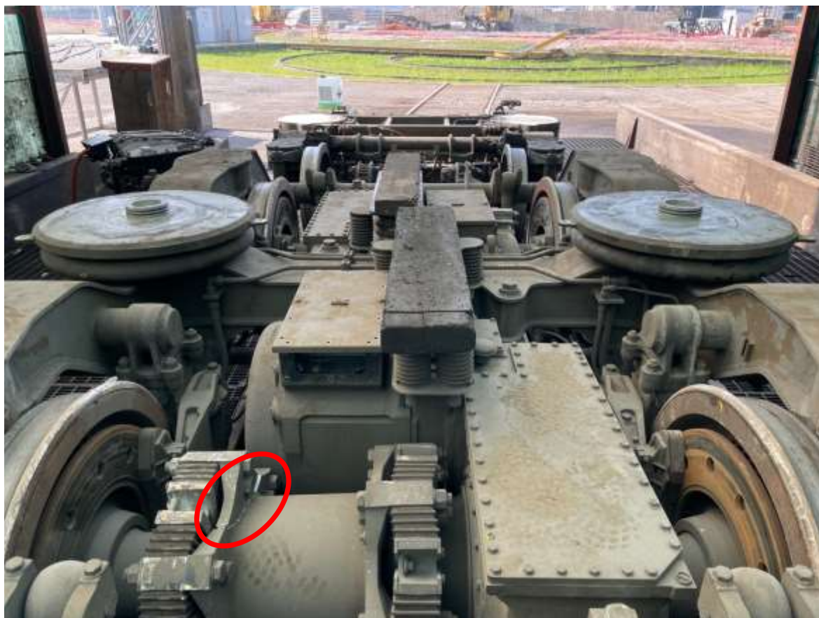
Figura 23 – Esempio di danni al carrello (fonte immagine: Ufficio; elaborazione: Ufficio).
