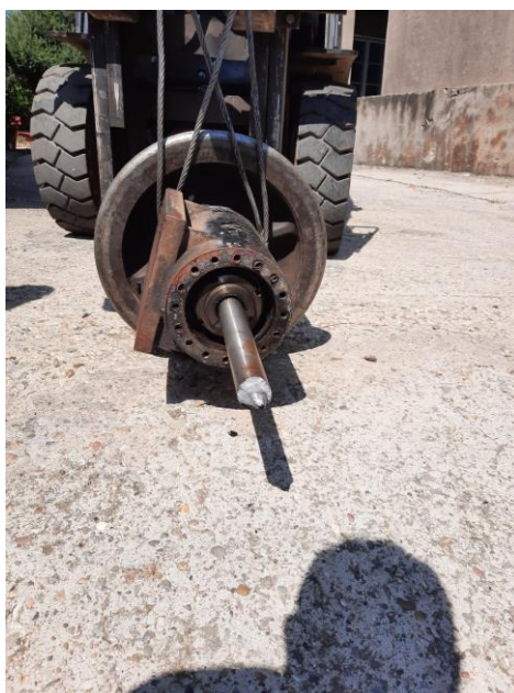
foto nr.2. - ansamblu roată-butuc-ax intermediar (planetar) demontat
