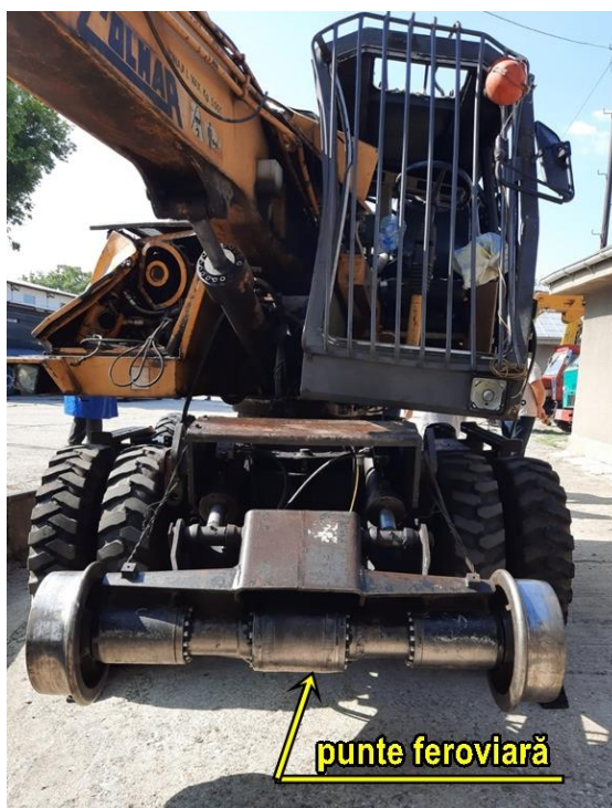
foto nr.1 - puntea feroviară nr.2, implicată în deraiere
