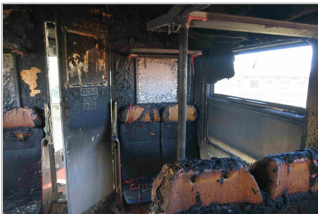
Obr. č. 7: Požárem zničený interiér ŘDV – pohled směrem ke stanovišti strojvedoucího.
