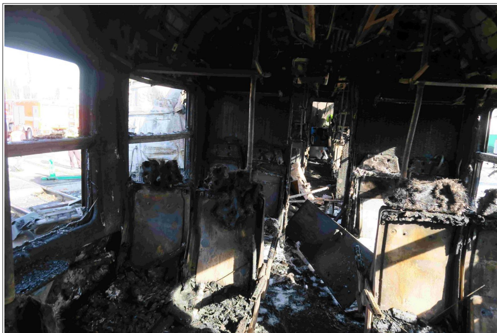
Obr. č. 6: Požárem zničený interiér ŘDV – pohled směrem do oddílu pro cestující.
