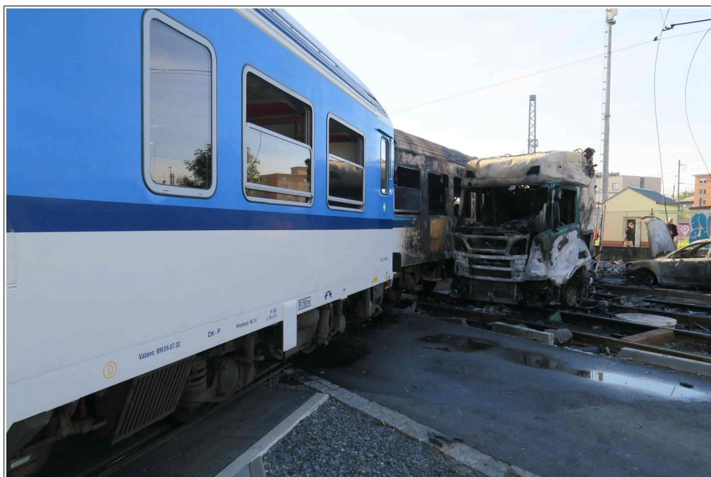
Obr. č. 4: Pohled na požárem zasažený tahač NA a DV vlaku Os 3542 po MU.
