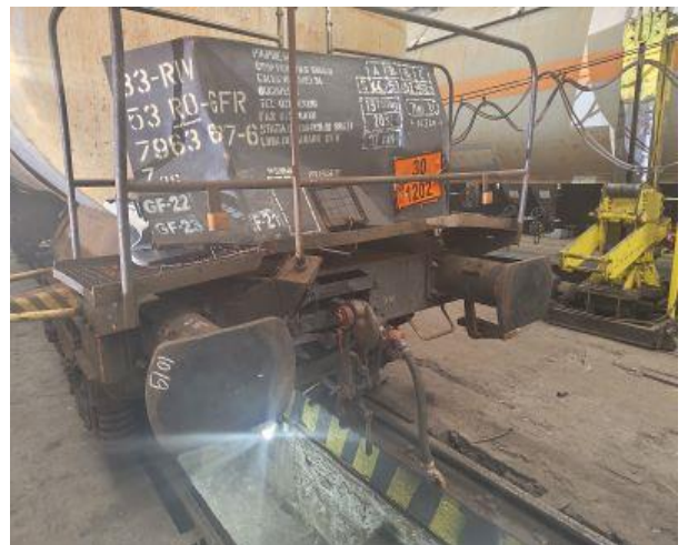
Foto nr.3 - Recipient deformat vagon nr.33537963637-6
