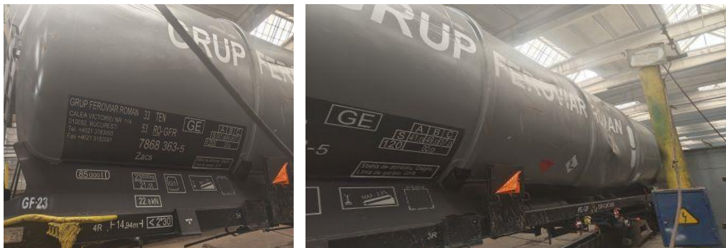
Foto nr.4 - Recipient deformat vagon nr.33537868363-5
