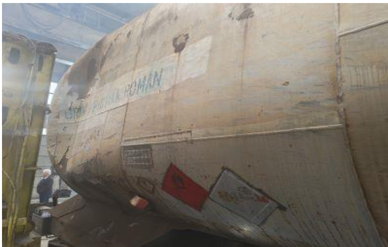
Foto nr.3 - Recipient deformat vagon nr.33537963637-6
