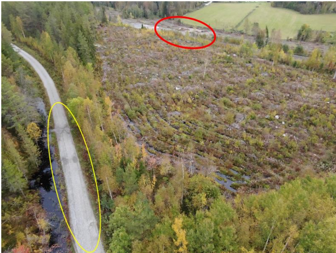
Figur 8. Markområdet och slänten ned mot olycksplatsen. Bilden är tagen den 29 september 2023. Gul markering visar områden där vatten från överliggande områden tidigare har svämmat över vägen (mörka fläckar). Röd markering visar olycksplatsen.
