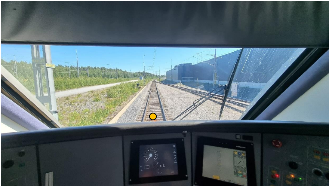
Figur 17. Lokförarens observationsfält framåt i förarhytten på motorvagn av typen X55. Den orangea punkten på spåret är cirka 7 meter framför fordonets front. Foto: SJ AB.
