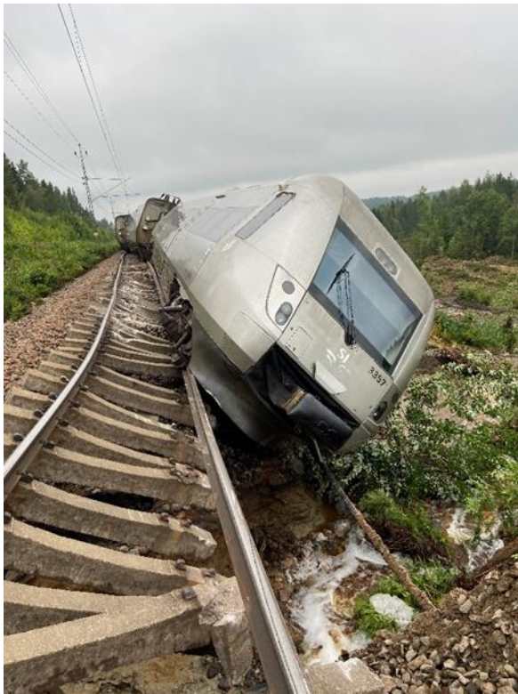
Figur 2. Bild som visar de tre bakersta vagnarna och vattnet som forsar genom den rasade banvallen.
