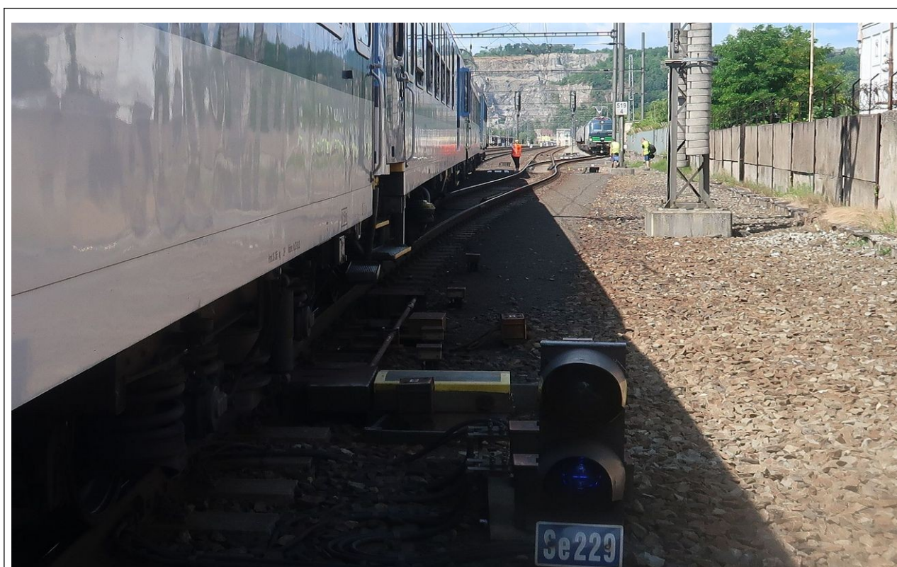
Obr. č. 6: Pohled na místo souběhu průjezdných průřezů vlaků R 677 a Nex 55320 na výhybce č. 246
