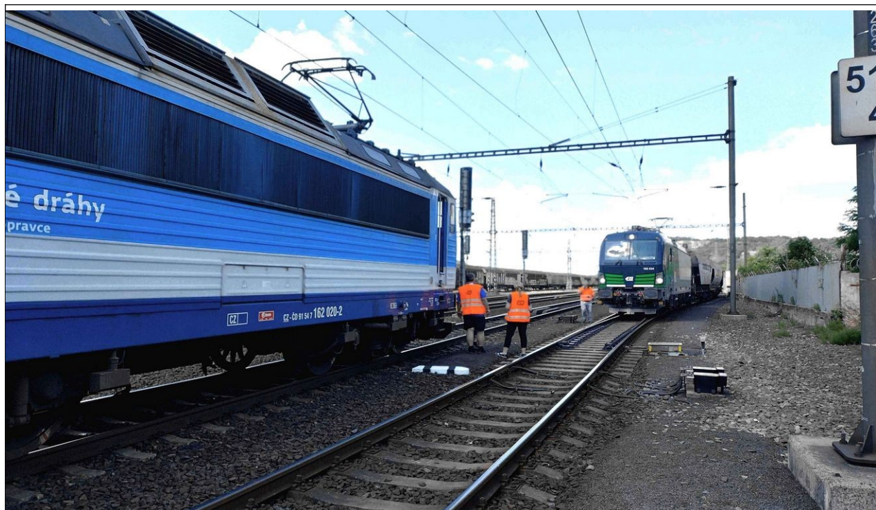
Obr. č. 5: Pohled ve směru jízdy vlaku R 677: konečné postavení vlaků, námezník výhybky č. 246, výhybka č. 242 byla přestavena ve směru nedovolené jízdy vlaku Nex 55320.
